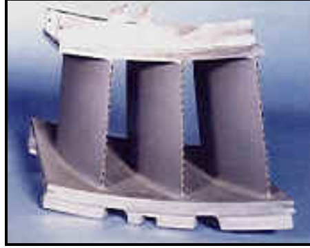
Şekil 2.19. Termal püskürtme kaplama teknolojisinin uygulandığı gaz türbin kanatları [14]
