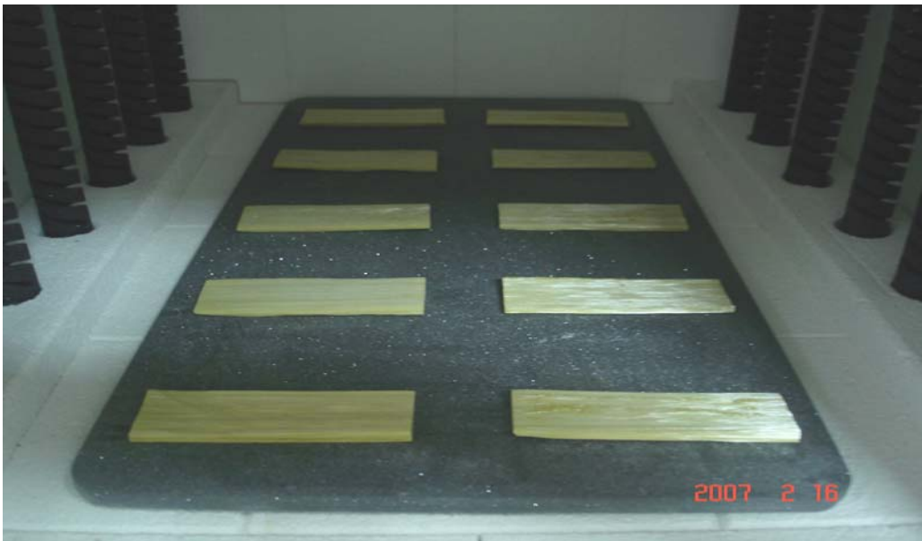
Şekil 4.32. Orta tabaka için 600°C’lik ısıl işlem sonucu fırındaki CTP numuneleri
