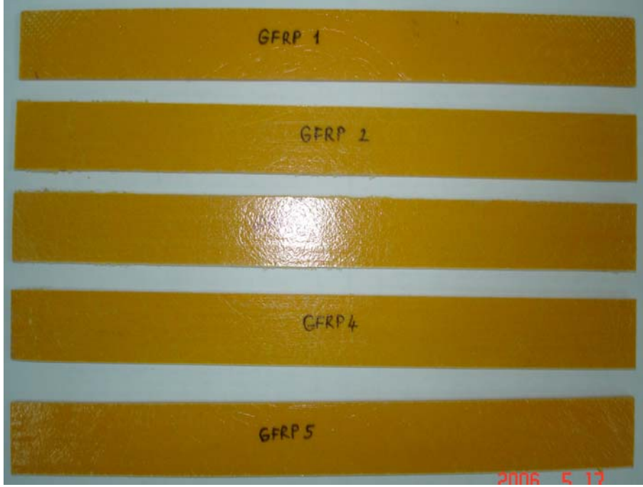
Şekil 4.4. Profillerden kesilmiş CTP numuneleri
