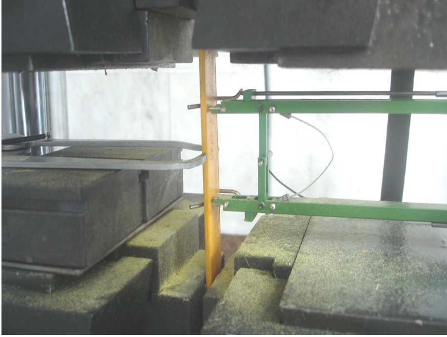
Şekil 4.14. Extansometre ve komparatör saatinin numuneye montajı
