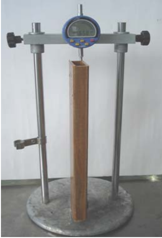
Şekil 4.22. Isı genleşme deyinde numune boylarının ölçülmesi
