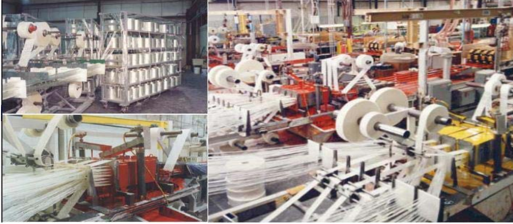
Şekil 3.9. Fitol sehpaları (Elyaf bobinleri) [31]
