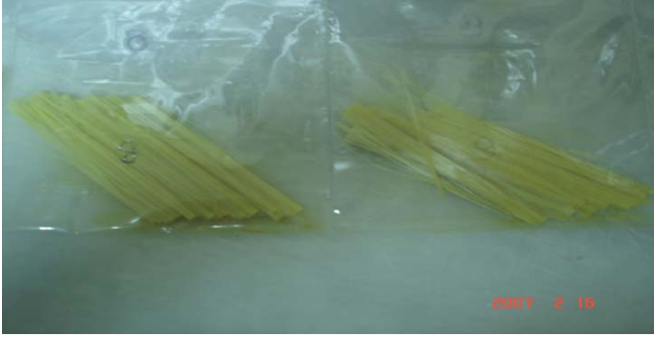
Şekil 4.33. 600 °C’lik ısıl işlem sonucu fırından çıkarılan orta bölgedeki boyuna fiberler
