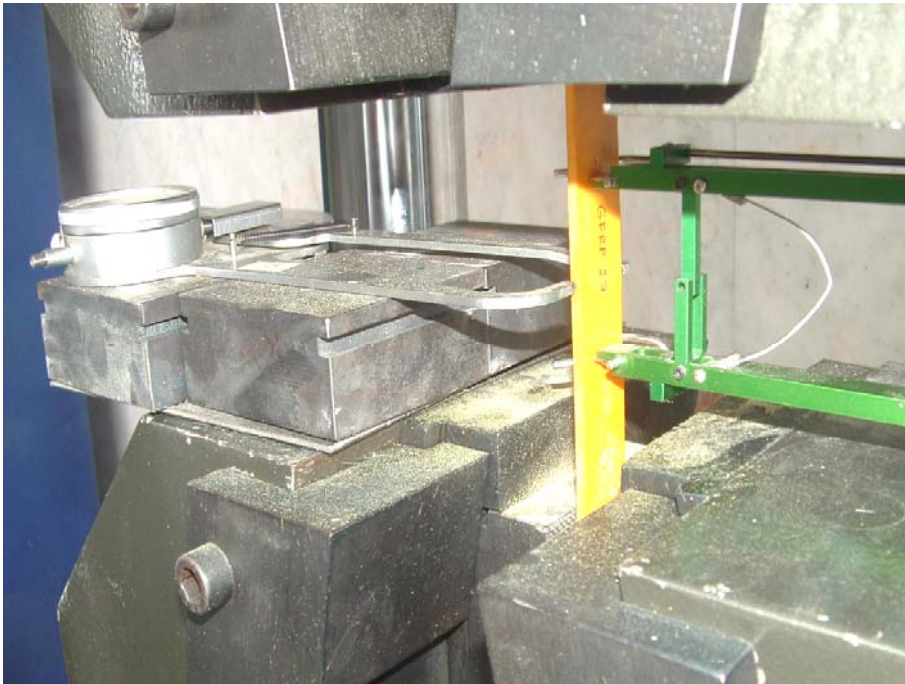
Şekil 4.13. Poisson Oranı deneyi öncesi oluşturulan düzeneğe
