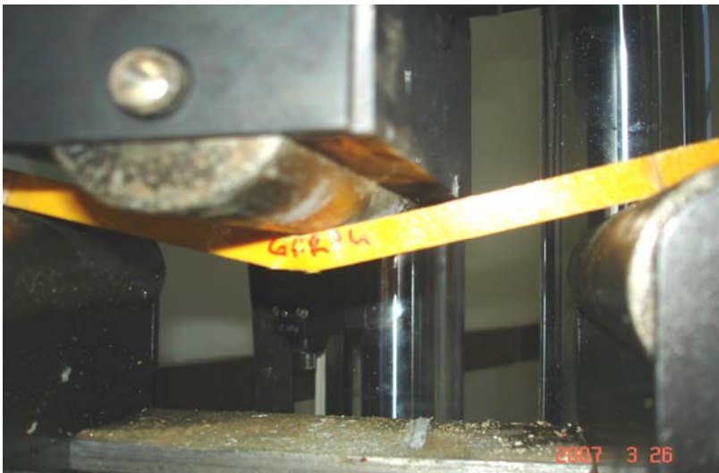
Şekil 4.20. Dikdörtgen dolu kesitli eğilme deneyinde kırılmış numune örneği
