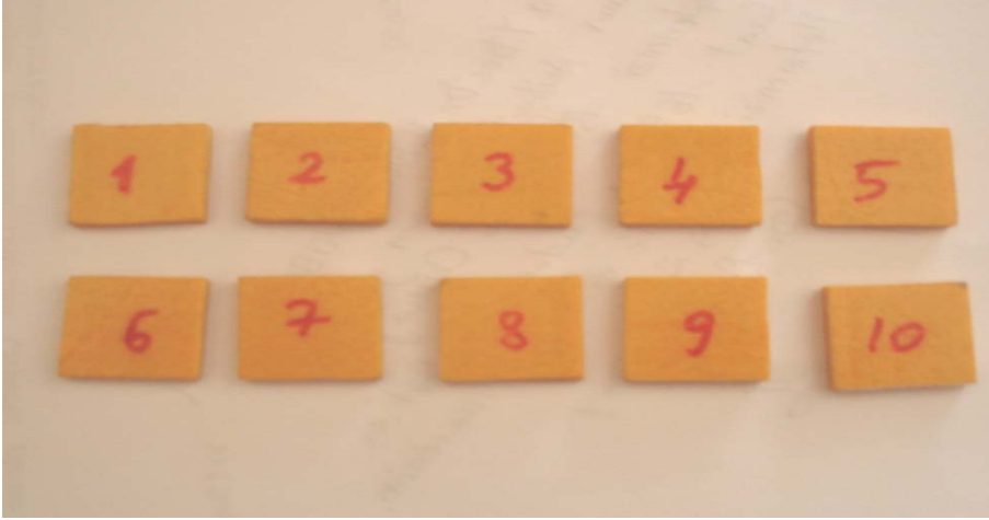
Şekil 4.28. Tüm tabakadaki fiber ve matriks oranlarının belirlenmesi için hazırlanan numuneler
