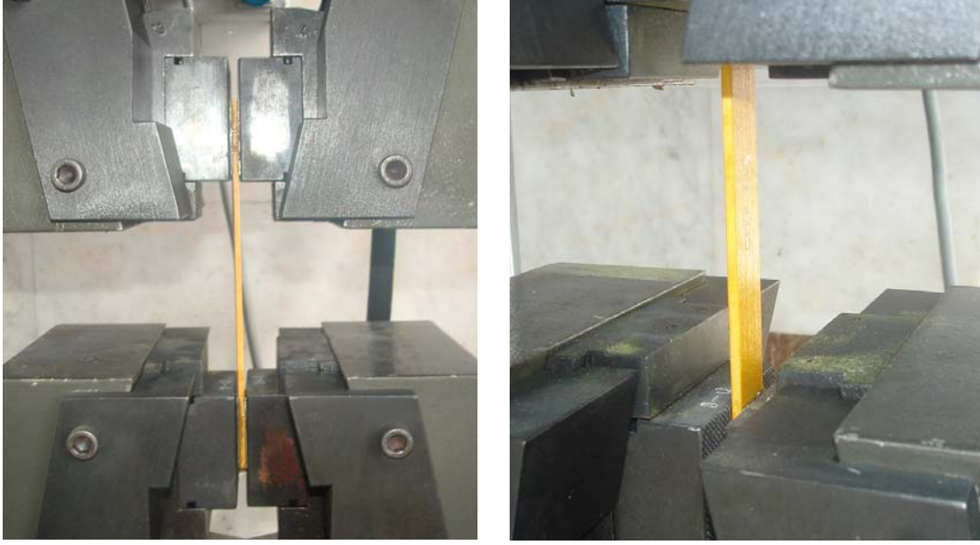
Şekil 4.6. Makine çenelerine sıkıştırılmış numuneler
