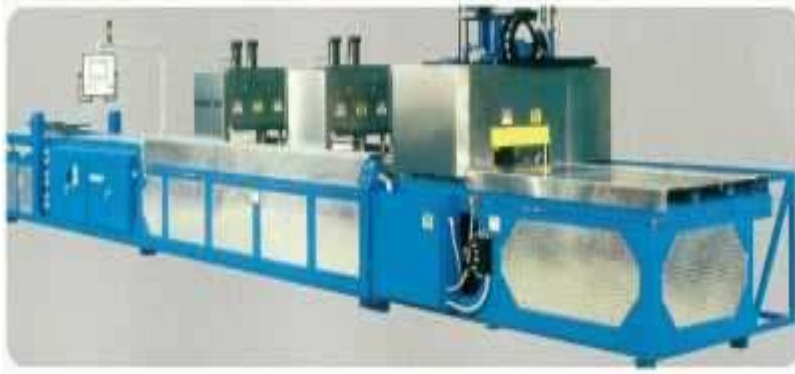
Şekil 3.8. Profil çekme makinesi [32]
