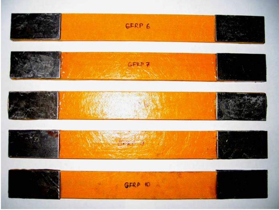
Şekil 4.5. Metal başlık yapıştırılmış numuneler
