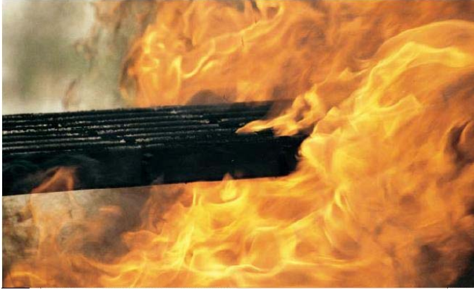
Şekil 3.15. Alev dayanımı sağlanmış profil
