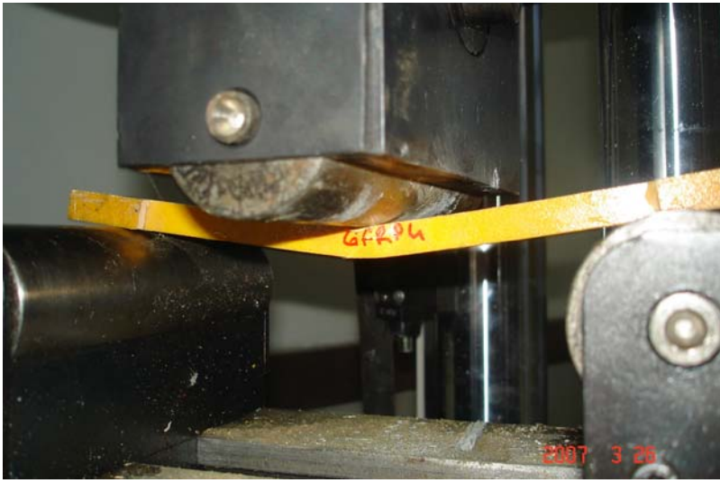
Şekil 4.19. Dikdörtgen dolu kesitli eğilme deneyi yüklemesi
