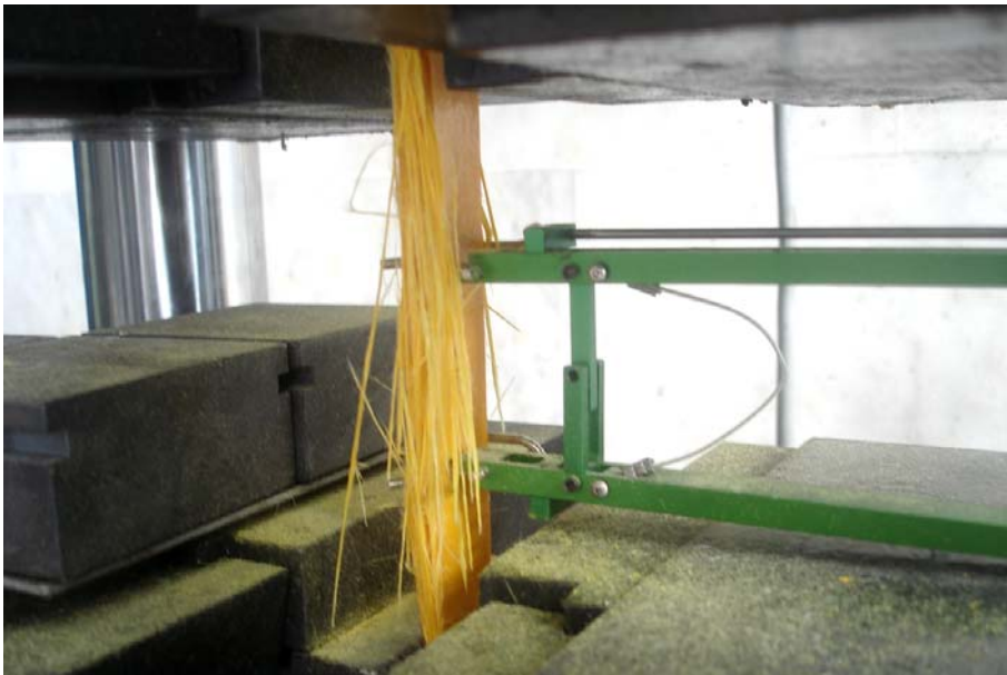
Şekil 4.8. Çekme testi yapılmış numune
