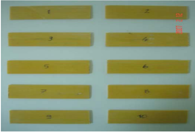
Şekil 4.31. Orta bölgedeki fiber ve matriks oranlarının belirlenmesi için hazırlanan numuneler
