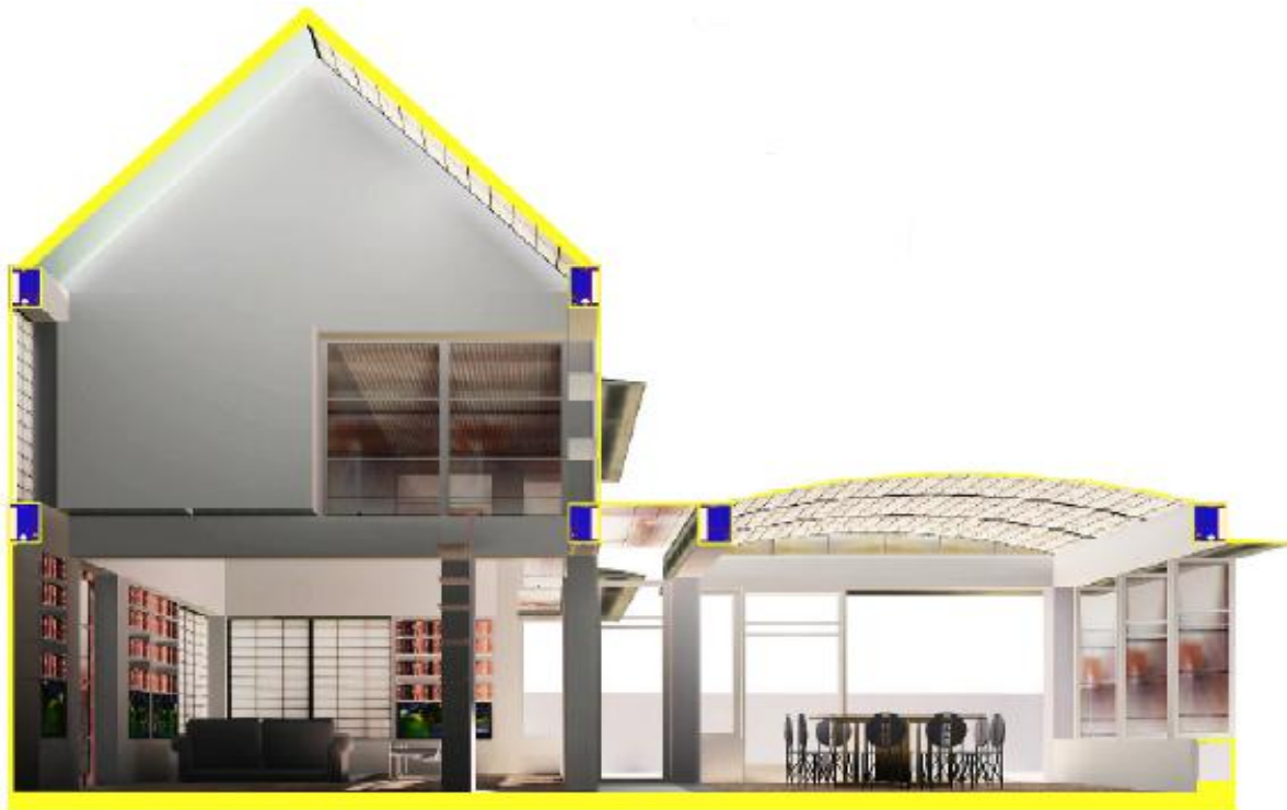
Şekil 2.5. Pultrüzyonla üretilmiş CTP kullanılarak yapılmış prototip yapı (MIT)
