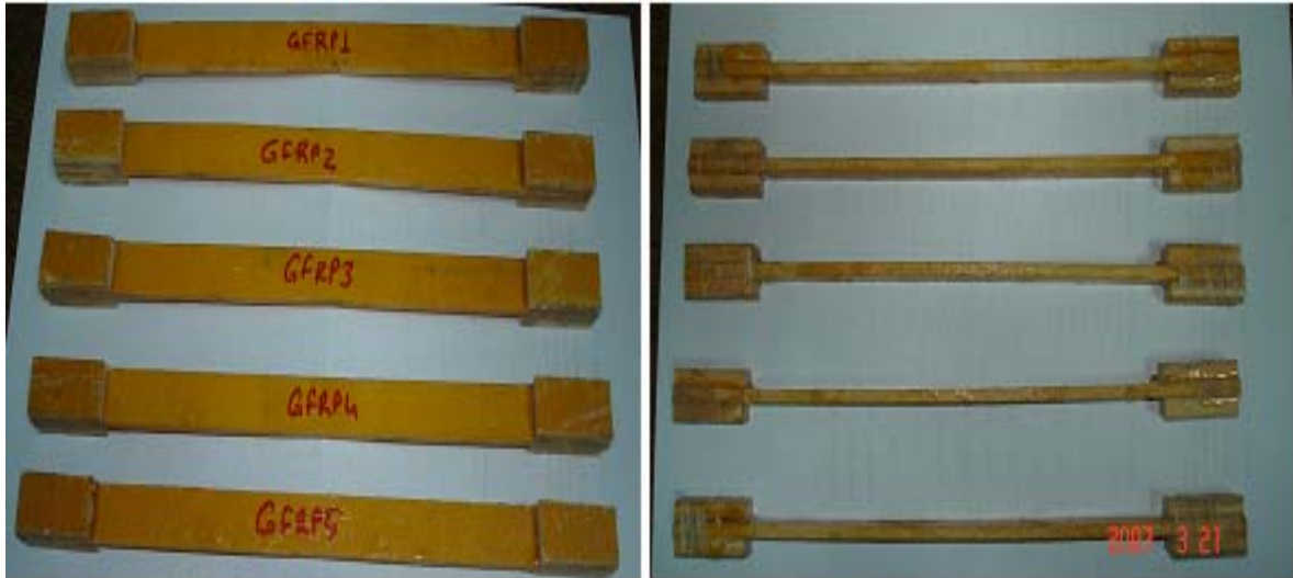
Şekil 4.18. Dikdörtgen dolu kesitli eğilme deney numuneleri
