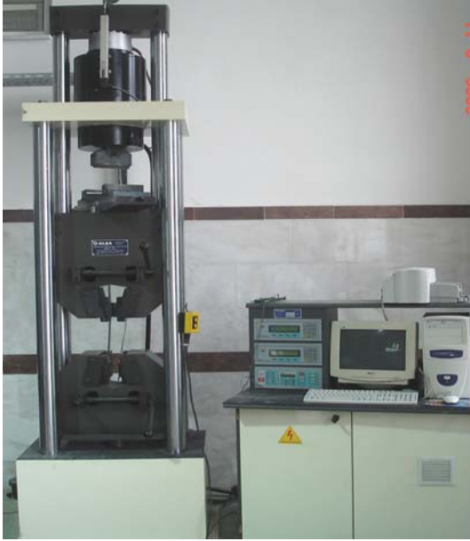
Şekil 4.2. Çekme makinesi ve donanımı
