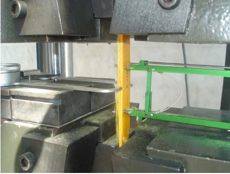
Şekil 4.15. Poisson Oranı deneyi sonrası
