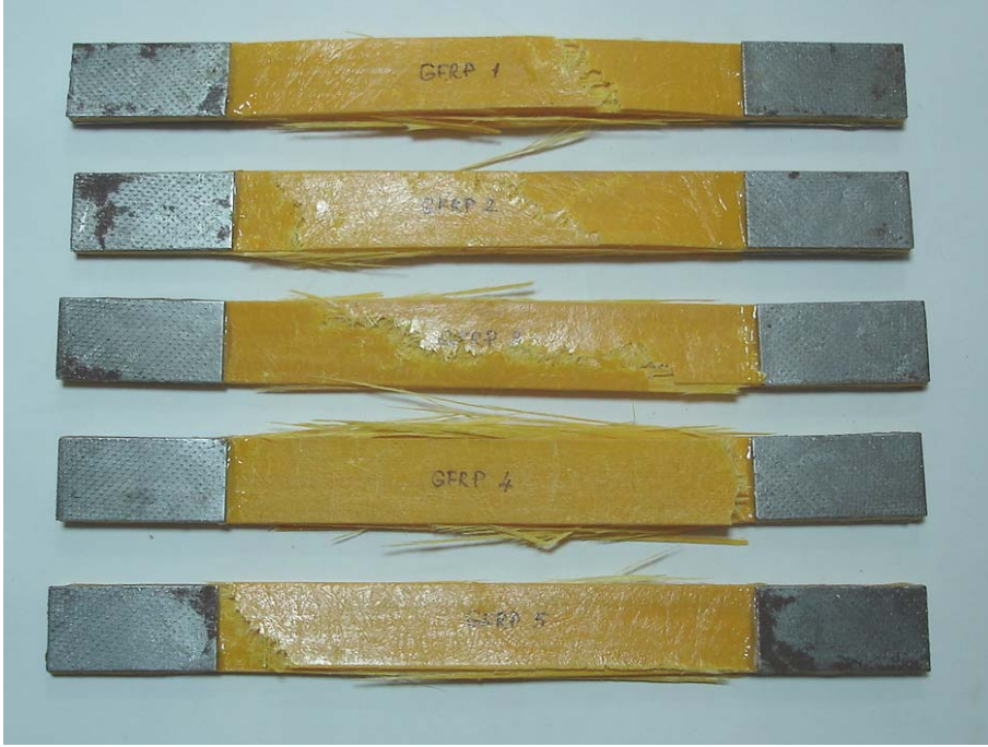
Şekil 4.9. Çekme deneyi yapılmış numuneler
