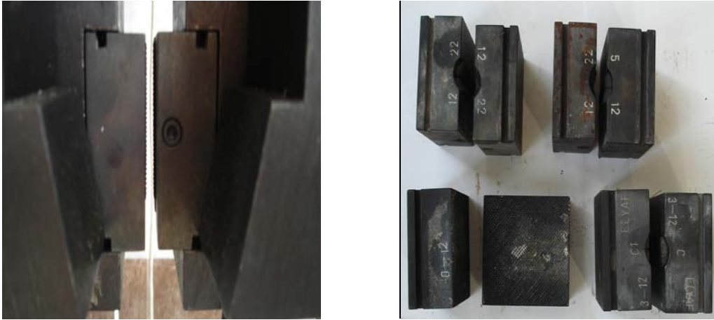
Şekil 4.1. Çekme makinesi çeneleri ve düzeneği
