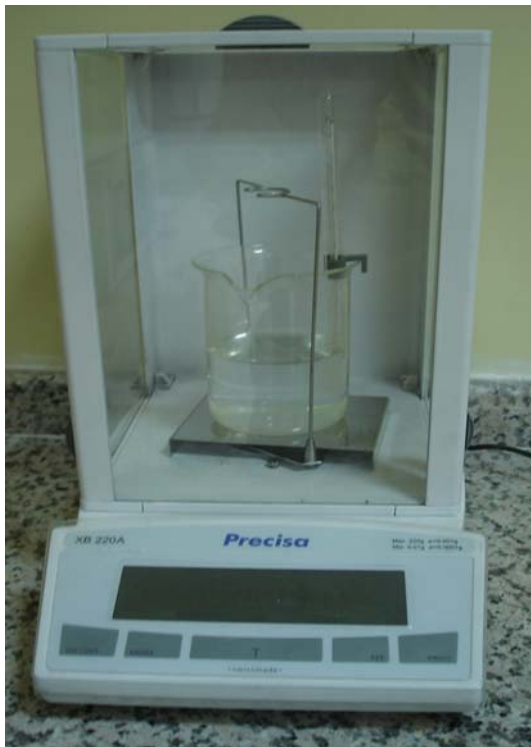
Şekil 4.27. Arşimet terazisi ve özgül ağırlık numuneleri
