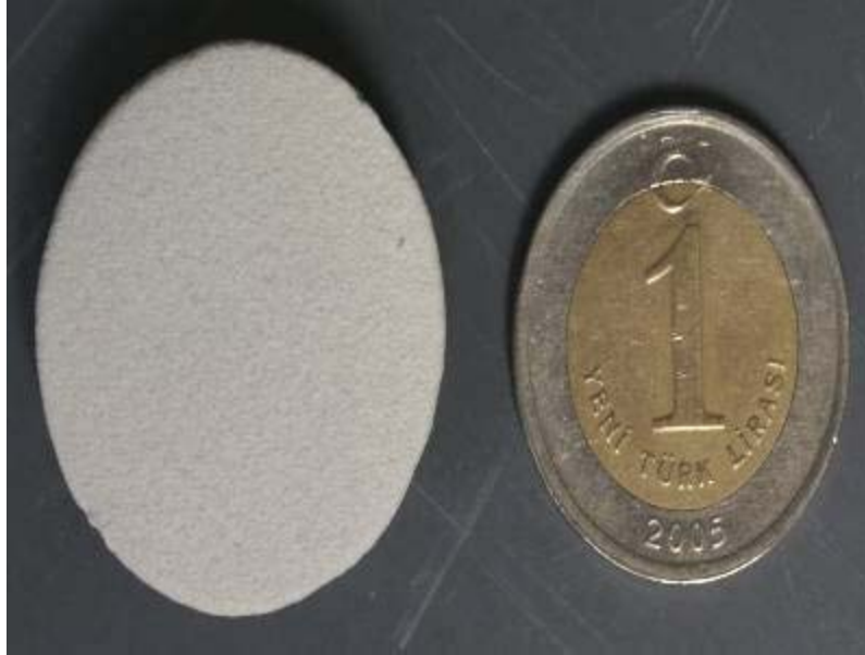
Şekil 6.30. Z kodlu bileşimine sahip kaplamanın termal şok öncesi makro görüntüsü
