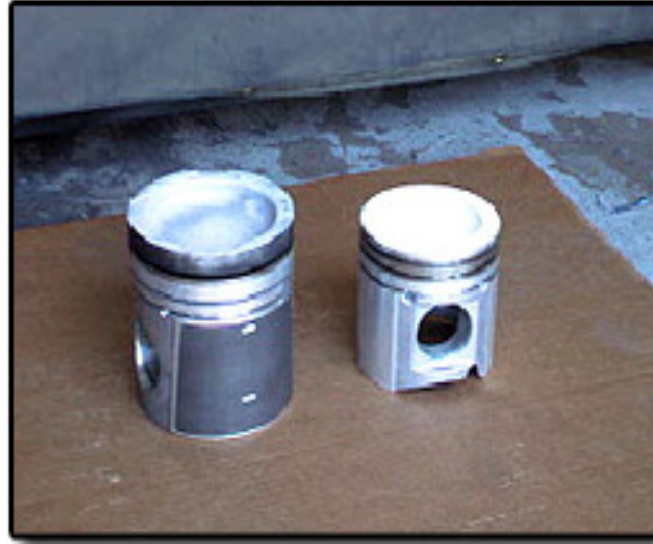
Şekil 2.21. Termal bariyer kaplanmış dizel motor pistonları [34]
