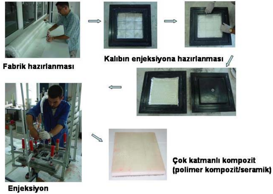
Şekil 2.9. RTM Yöntemiyle Kompozit Panel Üretim Adımları [20]
