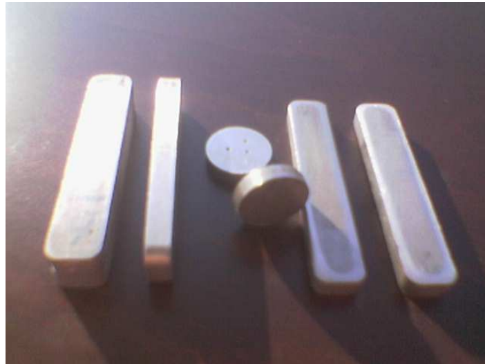
Şekil 4.1. Mikroyapı incelemelerinde ve mekanik deneylerde kullanılmak amacıyla T/M ile üretilmiş çeşitli numuneler
