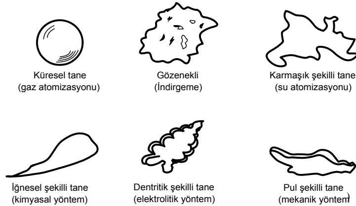
Şekil 2.12. Toz üretim yöntemine göre tane şekillerinin değişimi [41]
