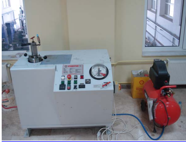
Şekil 5.6 Çalışmalarda kullanılan soğuk izostatik pres (CIP)
