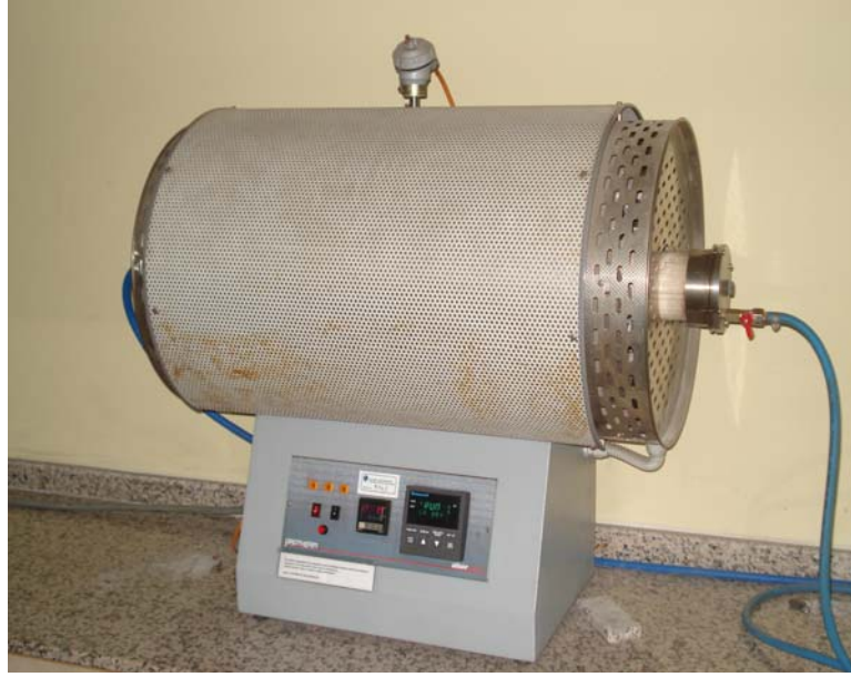
Şekil 5.3 Deneylerde kullanılan yatay tüp fırın.
