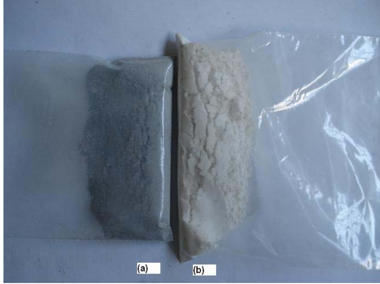
Şekil 6.1 (a) 12 dakikalık öğütme işlemi sonrasındaki kuartz minerali, (b) öğütme işlemine uğramamış kuartz minerali
