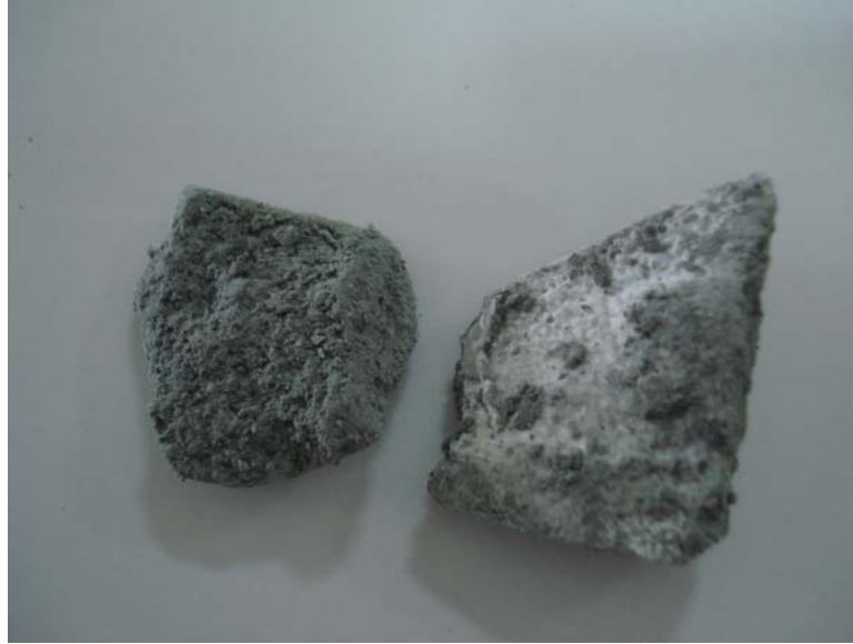
Şekil 6.2 KTİN reaksiyonu sonrasında elde edilen süngerimsi \text{Si}_3\text{N}_4
