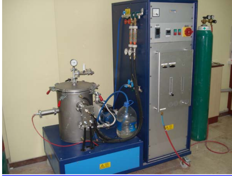
Şekil.5.7 Sinterleme çalışmalarında kullanılan yüksek sıcaklık fırını
