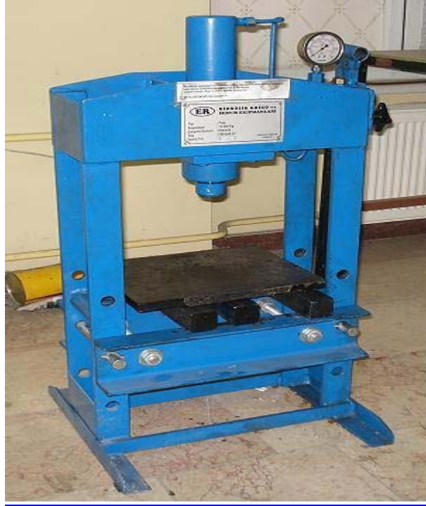
Şekil.5.5 KTİN reaksiyonuna tabi tutulmuş \text{Si}_3\text{N}_4 tozlarının preslenmesinde kullanılan izostatik pres
