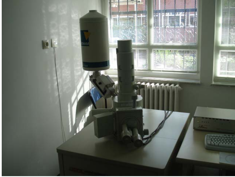
Şekil.5.8 SEM ve EDS analizlerinde kullanılan Jeol Jsm-6060LV marka taramalı elektron mikroskobu
