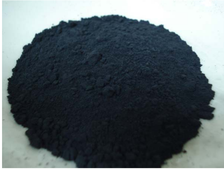
Şekil 5.1 Stokiyometrik orana göre karıştırılmış Kuartz mineralleri ile Karbon karası
