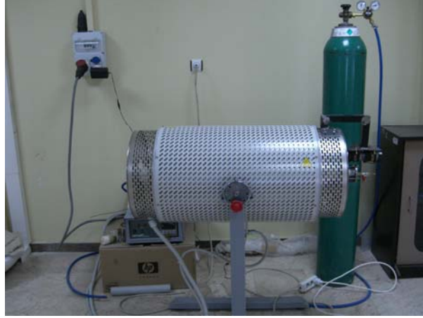
Şekil 4.3. Sinterleme işlemlerinde kullanılan fırın ve düzenek
