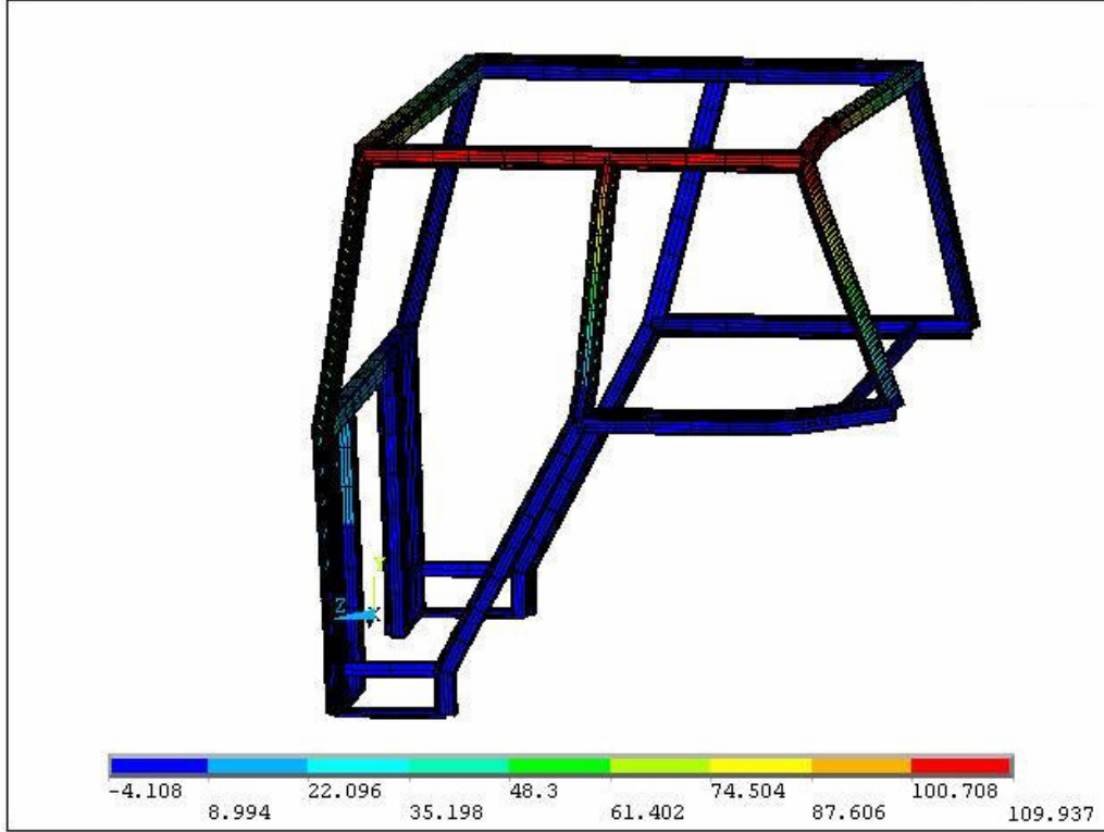
Şekil 4.22. Arkadan Yatay Yüklemede Meydana Gelen Yer Değişimleri
