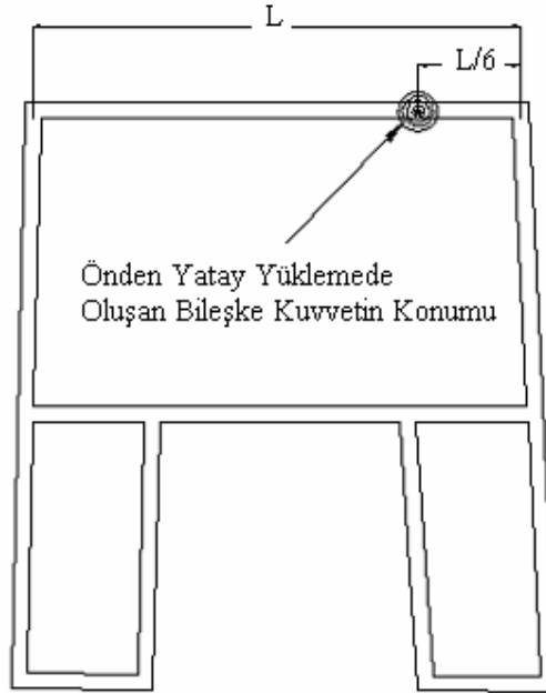
Şekil 2.6. Önden Yatay Yüklemede Bileşke Kuvvetin Oluştugu Nokta
