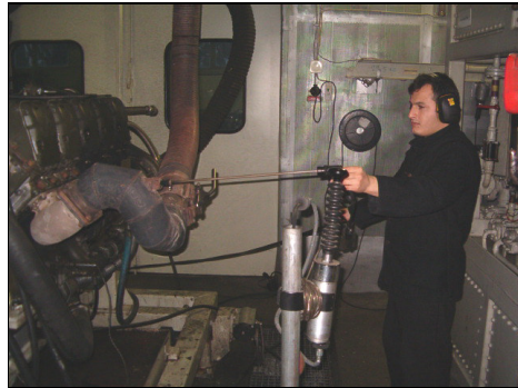
Resim 4.20. Emisyon ölçümünün yapılması
