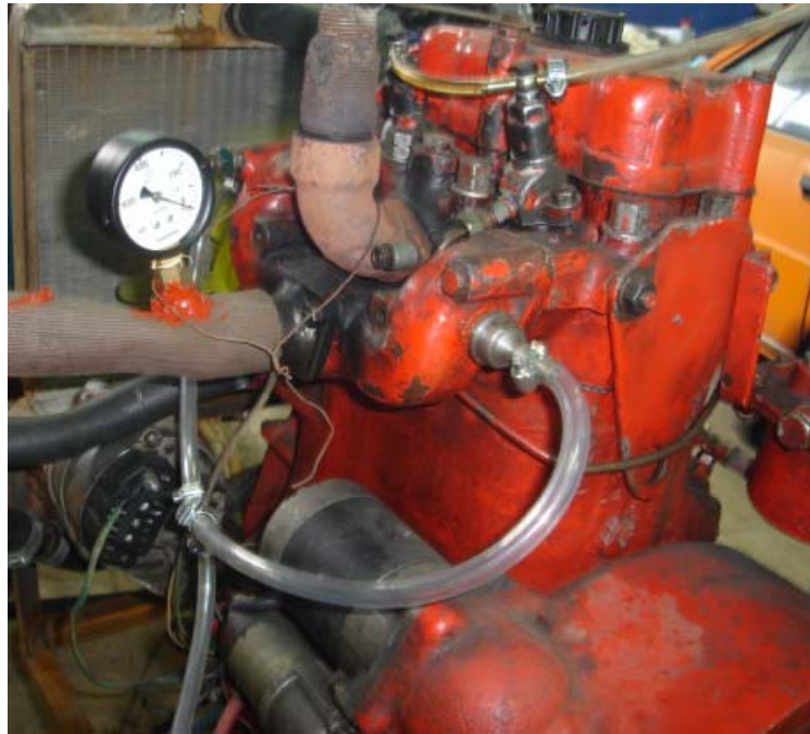
Şekil 5. 2. Deney motoru, pilot enjektörler ve emme havası manometresi
