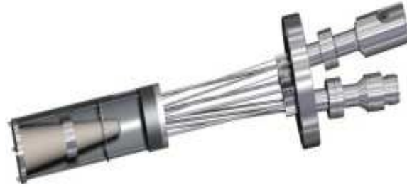
Şekil 3.27. İdeal kaynak hücresi (effusion cell) [10].
