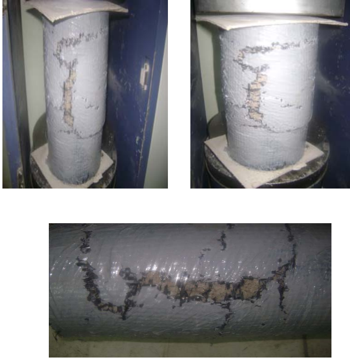
Şekil 4.3. Karbon elyaf sarılı silinindir numunelerin preste kırılması
