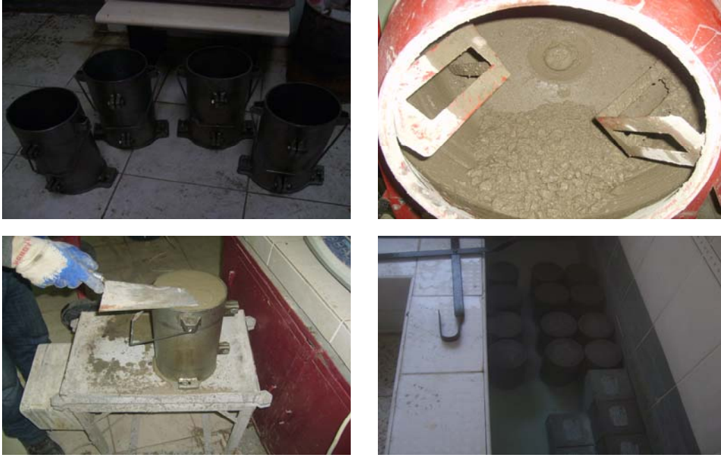
Şekil 3.17.Betonun dökümü ve kuru
