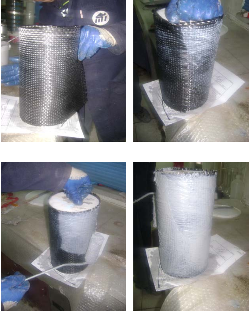
Şekil 3.19. Silindir numuneye çift kat karbon lifli kumaşın sarılması ve doyurma reçinesinin uygulanması
