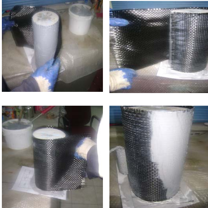
Şekil 3.18. Silindir numuneye tek kat karbon lifli kumaşın sarılması ve doyurma reçinesinin uygulanması
