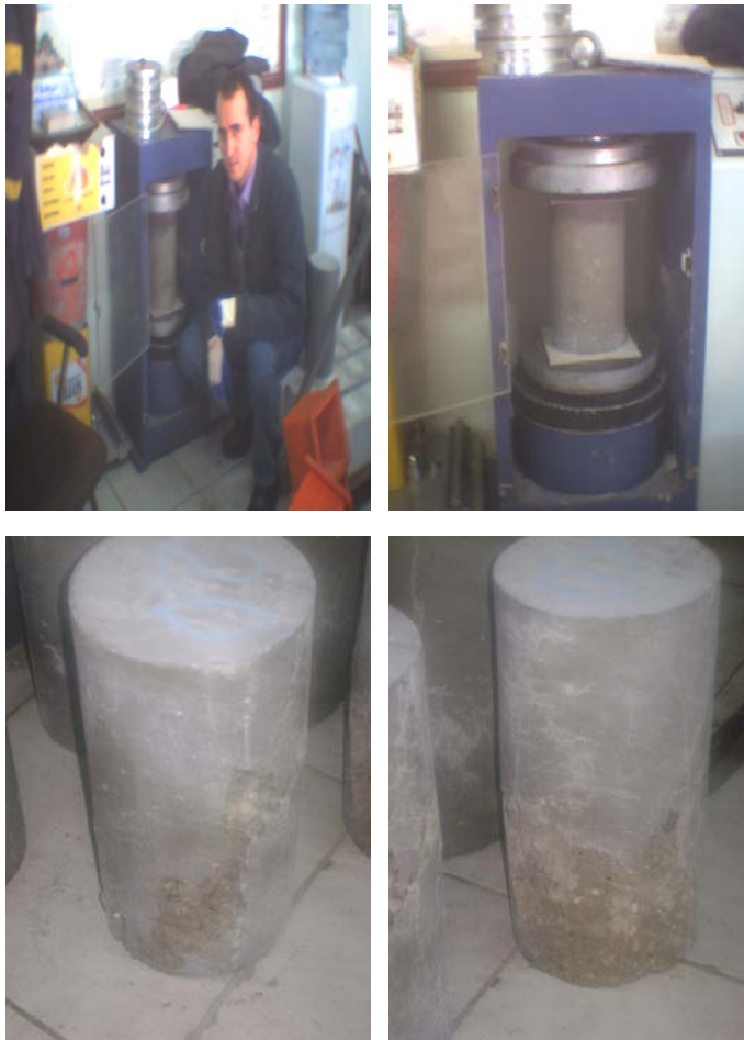
Şekil 4.1. 150 \times 300 \text{ mm} boyutlu silindirik şahit numunelerin preste kırılması
