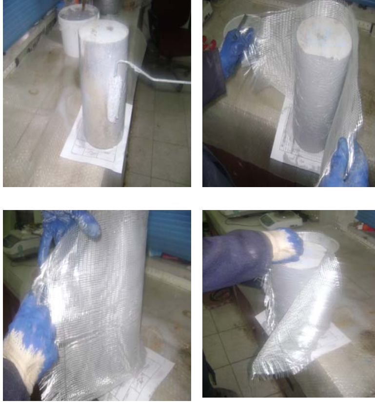
Şekil 3.20. Silindir numuneye tek kat cam elyafın kaplanması ve dourma reçinesinin uygulanması
