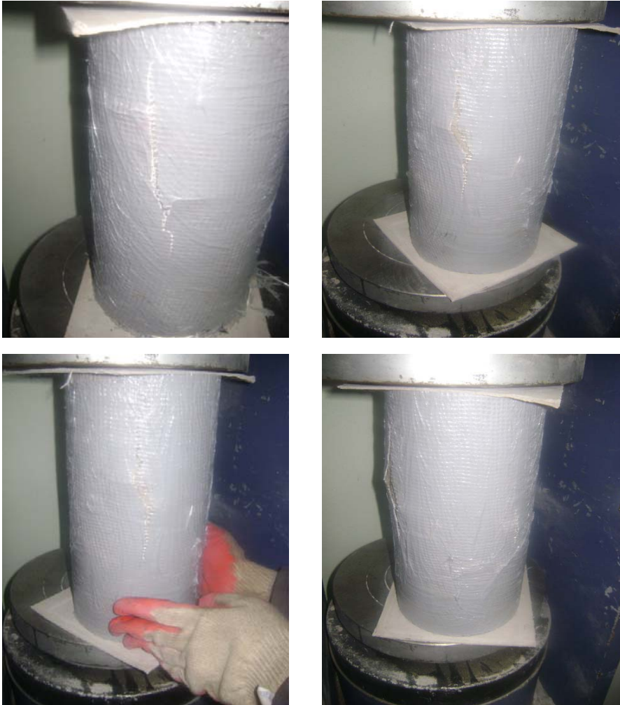
Şekil 4.2. Cam elyaf sarılı silindir numunelerin preste kırılması
