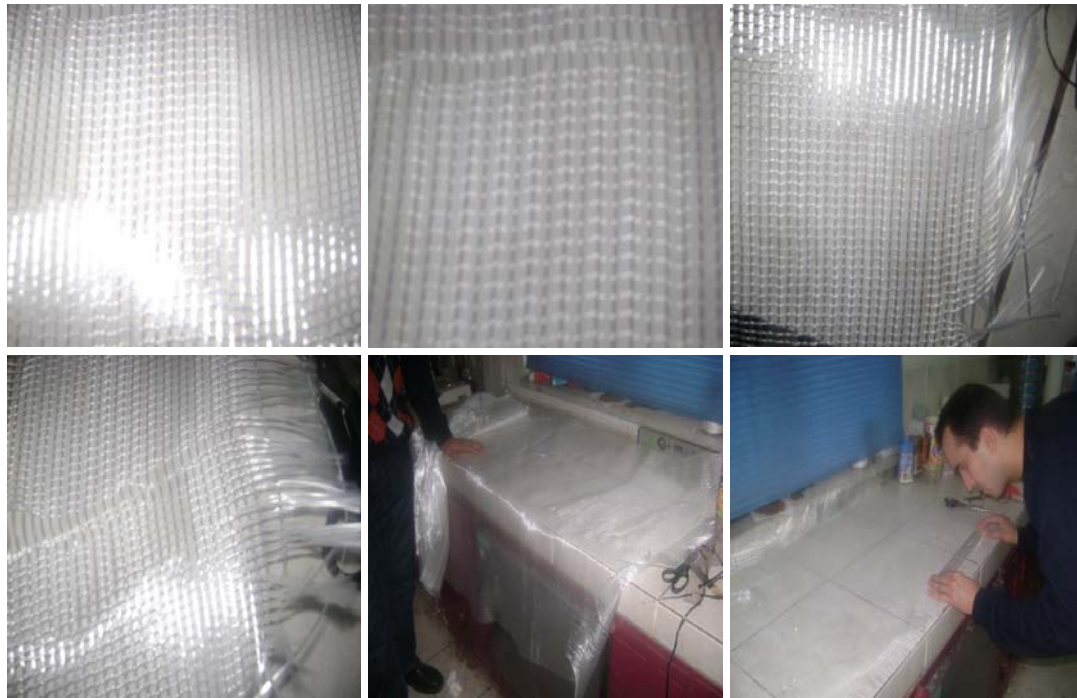
Şekil 3.14. Alkali dayanımlı cam elyaf ve uygulamaya hazırlanması
