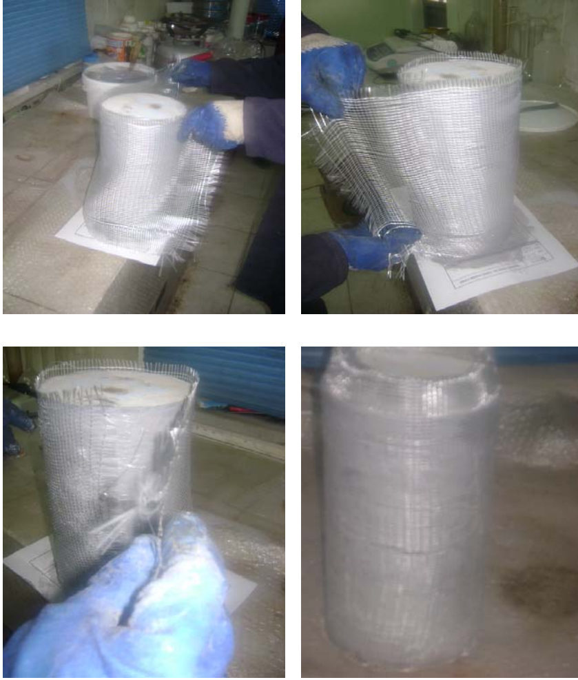
Şekil 3.21. Silindir numuneye çift kat cam elyafın kaplanması ve doyurma reçinesinin uygulanması
