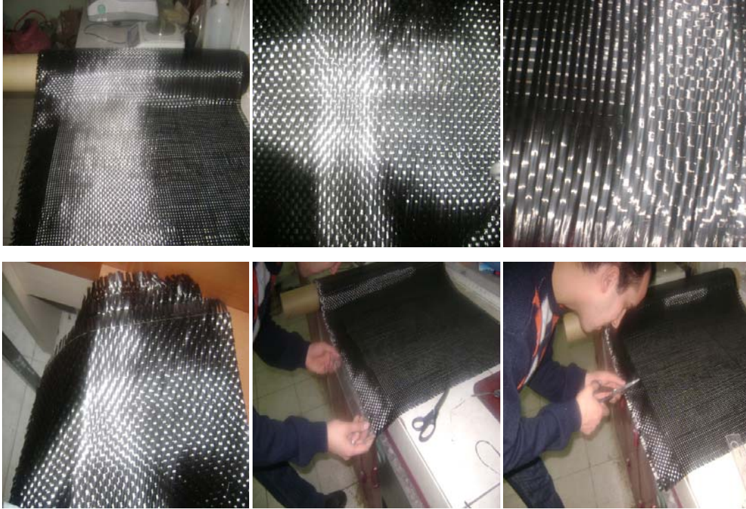
Şekil 3.3. Karbon lifli kumaş ve uygulamaya hazırlanması
