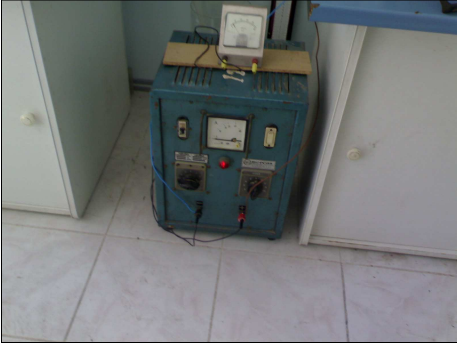
Şekil 4.6. Doğru akım güç kaynağının fotoğrafı
