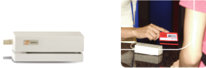
Şekil 2.5. Manyetik kart okuyucu ve kart okutma işlemi[10]
