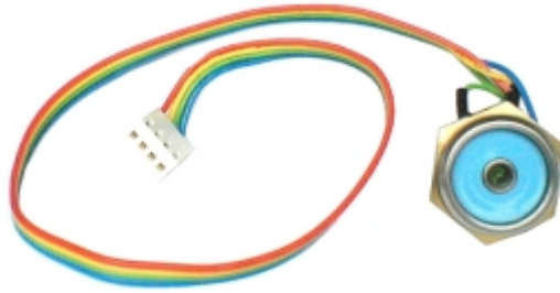
Şekil 3.20 DS9092L i-button probu [39]
