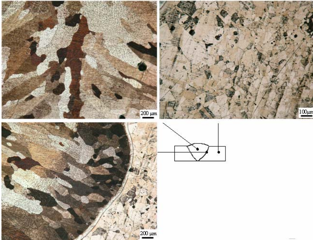
Şekil 6.1. Saf döküm nikel elektrotu kullanılarak elektrik ark kaynak yöntemiyle birleştirilen nikel malzemenin mikroyapı görüntüsü
