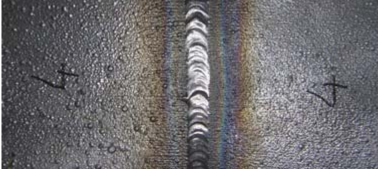
Şekil 6.30. Saf nikel malzemenin kaynaklı birleştirmeden sonraki görüntüsü.
