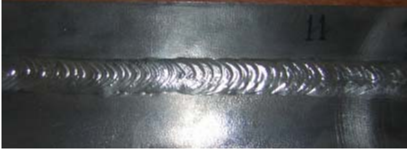
Şekil 6.48. Monel malzeme farklı koruyucu gazlar ve paso sayıları kullanılarak birleştirilen 12 mm kalınlığındaki monel malzemenin kaynatıldıktan sonraki görüntüsü.
