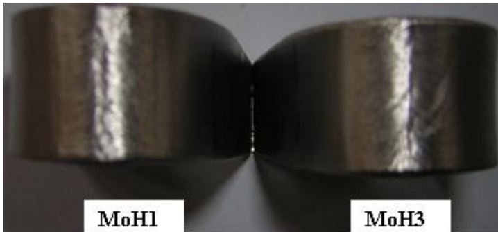
Şekil 6.47. a) Tek paso b) üç paso ile TIG kaynak yöntemi ve argon+%5 H 2 koruyucu gaz kullanılarak birleştirilen monel malzemenin eğme deneyinden sonraki görüntüsü.
