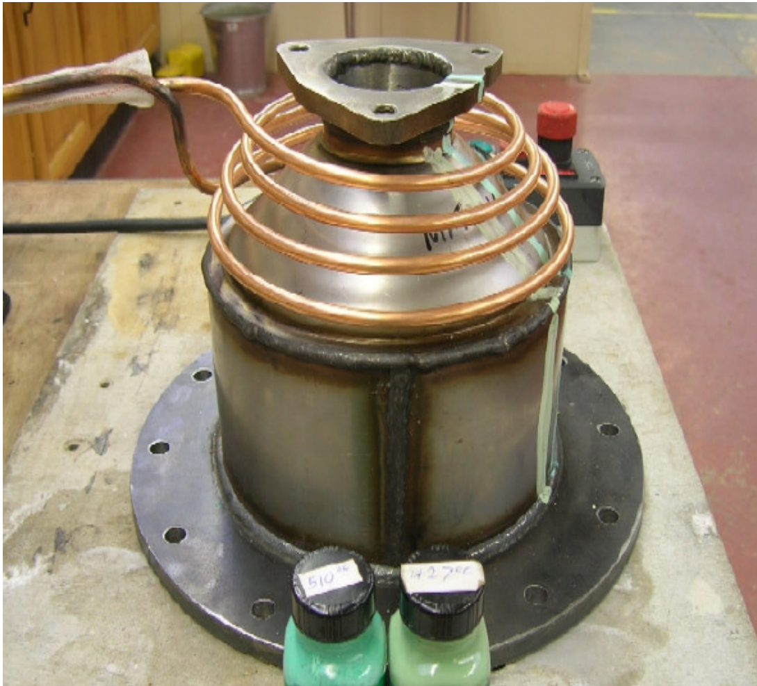
Şekil 1.7. İndüksiyonla ısıtma yönteminin, katalitik konverterin kaynak bağlantılarının ısıl testi amacıyla kullanılması [6]
