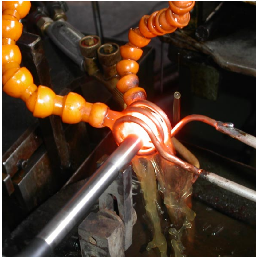
Şekil 1.2. İndüksiyonla ısıtım yöntemi ile rod başı sertleştirme [2]
