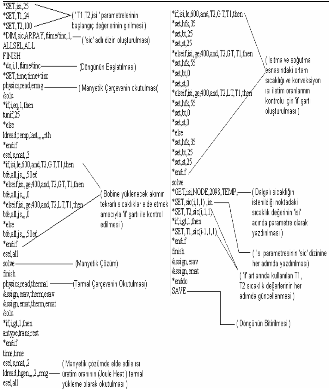
Şekil 5.16. 600 °C-400 °C arasında tekrarlı ısı yüklemesi için APDL çözüm döngüsü
