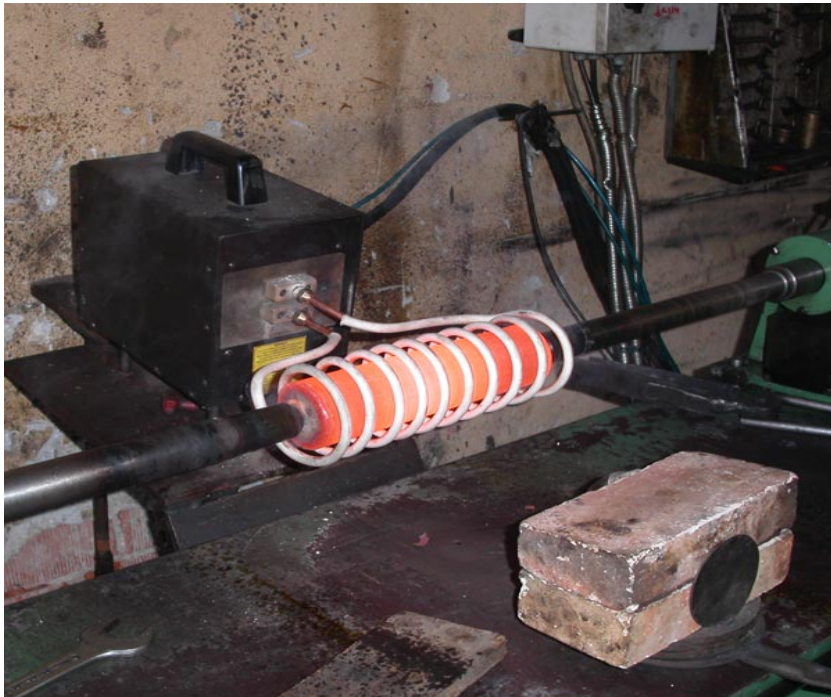
Şekil 1.4. İndüksiyonla ısıtma işlemi ile çelik tüp ısıtma [3]
