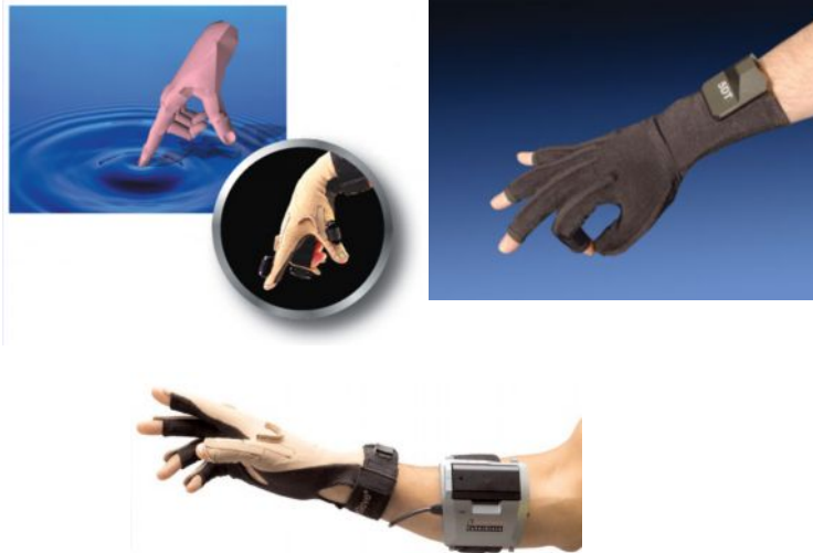
Şekil 2.14. Örnek veri eldiveni(data glove) modelleri
