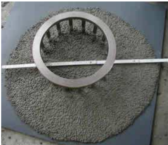
Şekil 4.4. J halkası deneyi
