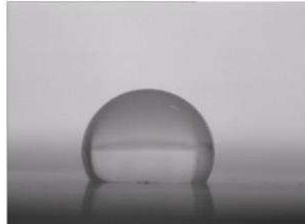
Şekil 6.33. Ag-PTFE kaplama üzerindeki su damlası [41]
