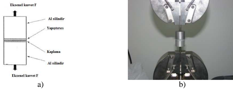
Şekil 5.23. ASTM C633 yapışma mukavemeti a) şematik çizimi b) test sırasındaki görünümü
