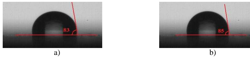
Şekil 6.26. Kumlanmış Al ve işlem görmemiş Al yüzeylerin kontak açıları a) kumlanmış b) işlem görmemiş
