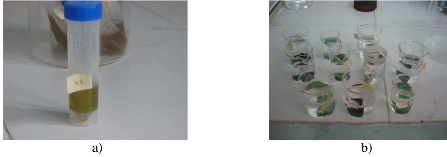
Şekil 5.22. İzosiyonat testi a) izosiyonat içindeki kaplama b) temizleme işlemi
