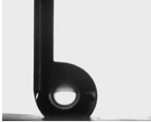
Şekil 6.32. PTFE kaplama üzerine su damlasının bırakılması [41]
