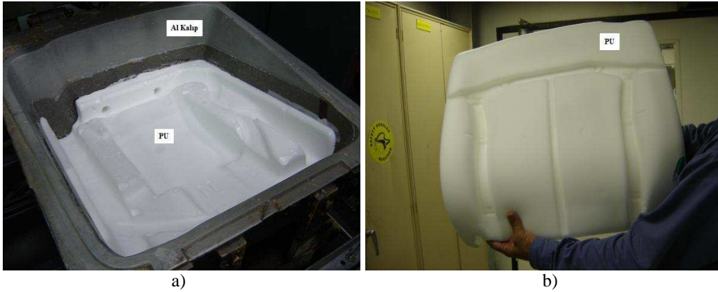
Şekil 3.1. PU Koltuk a) Al kalıp ve reaksiyonunu yeni tamamlamış PU sünger b) otomobil koltuğu üretiminde kullanılan PU sünger ürün [19]
