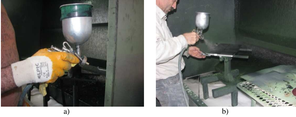
Şekil 5.8. Sprey ile kaplama işlemi a) kullanılan tabanca b) kaplama işlemi
