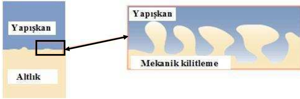
Şekil 3.2. Pürüzlü yüzey üzerinde yapışma mekanizması [ 21]
