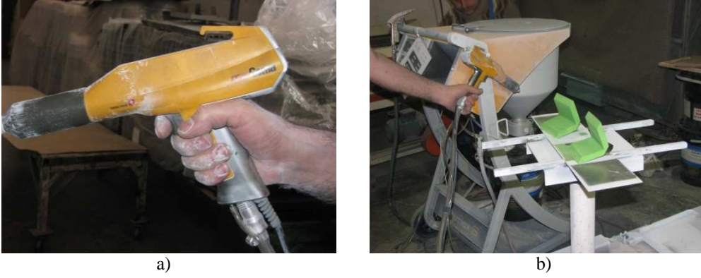
Şekil 5.9. Elektrostatik kaplama işlemi a) kullanılan tabanca b) kaplama işlemi
