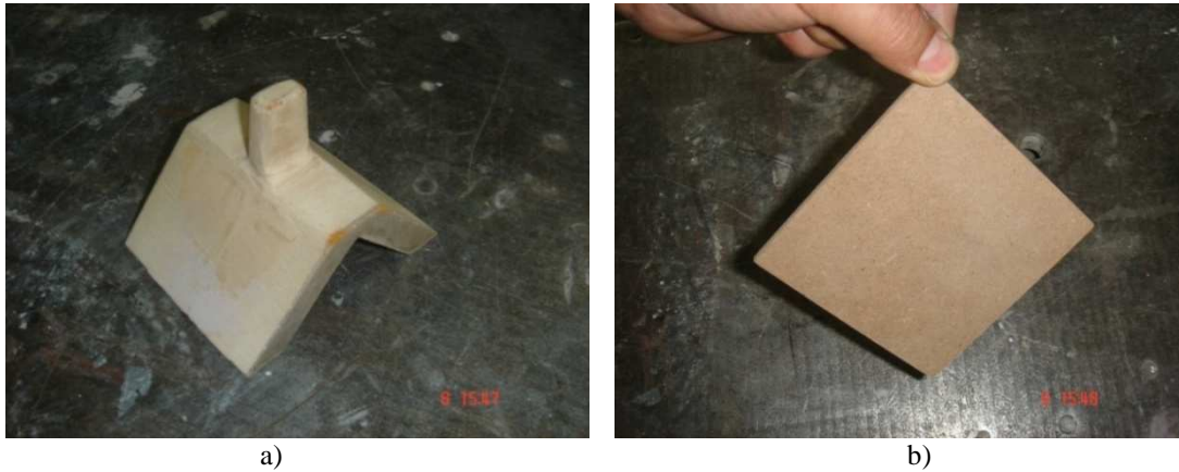
Şekil 5.2. Dökümü yapılacak altlık malzemelerinin ahşap modelleri a) kalıp numunelerin döküm modeli b) levhasal parçaların döküm modeli
