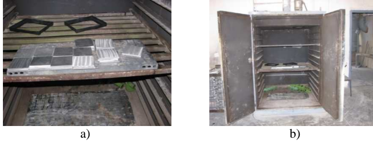
Şekil 5.7. Yakma işlemi ve kullanılan fırın a) numuneler b) fırın
