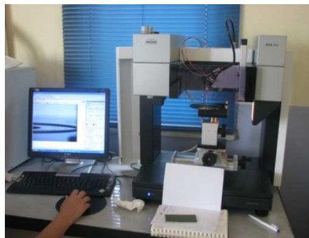
Şekil. 5.21. Kontak açısı ölçümü yapılan cihaz
