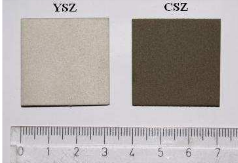
Şekil 4.7. Metalografik incelemelere yönelik üretilmiş numuneler
