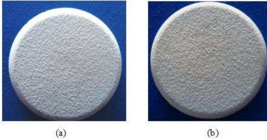
Şekil 5.10. YSZ 3 numunesi (a) termal şok öncesi (b) 100 çevrim sonrası görüntüsü
