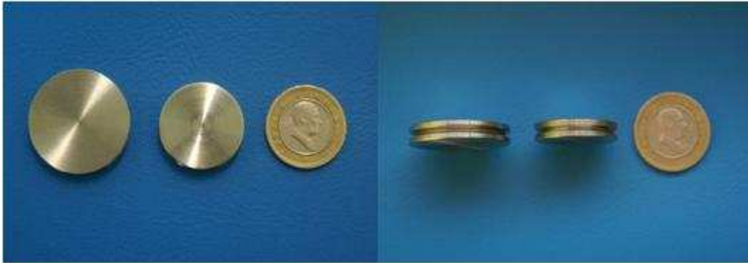
Şekil 4.8. Termal şok testi için işlenip kenarlarına yiv açılmış paslanmaz çelik altlıklar
