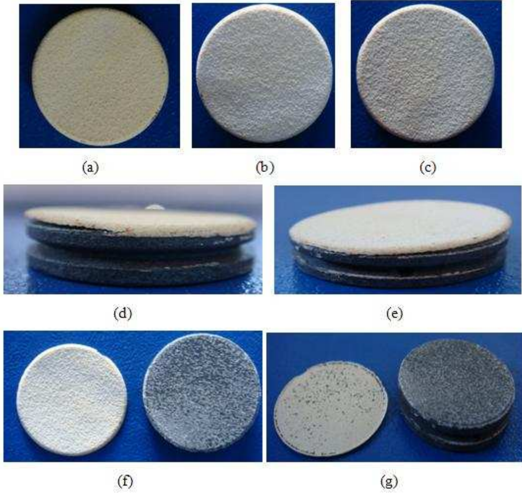
Şekil 5.12. YSZ 5 numunesi (a) termal şok testi öncesi (b) 45 (c) 60 (d) 77 (e) 80 (f) 82 çevrim ön yüzey (g) 82 çevrim arka yüzey görüntüsü
