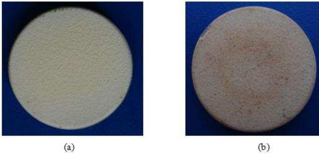
Şekil 5.3. YSZ 1 numunesi (a) termal şok öncesi (b) brülör testi 100 çevrim sonrası görüntüsü
