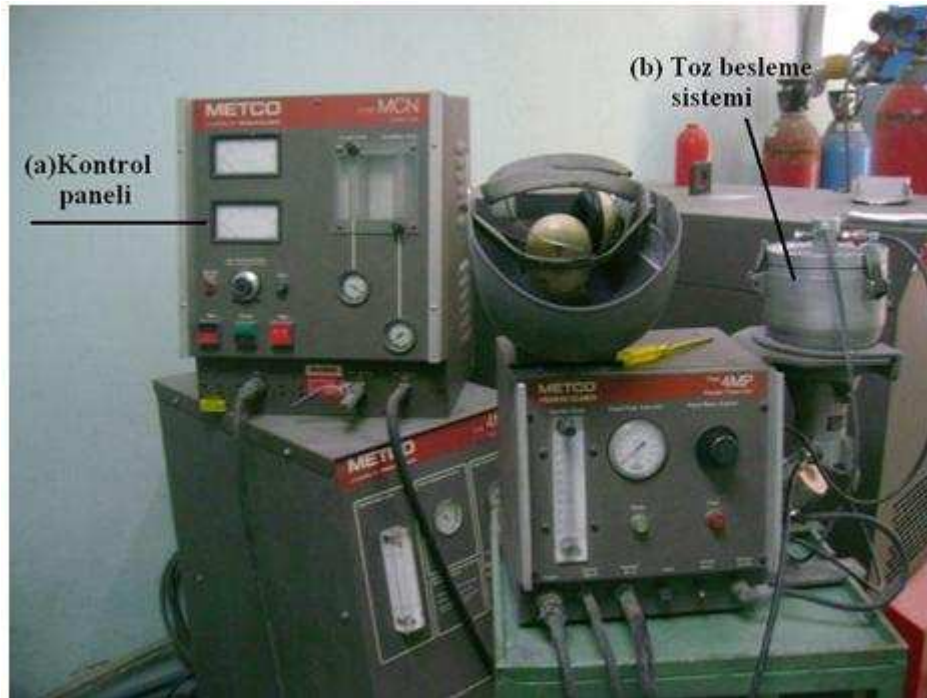
Şekil 4.4. Kaplama sistemi a) kontrol paneli b) toz besleme sistemi
