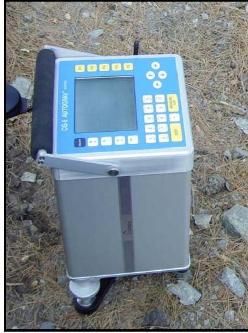
Foto 3.2. Çalışmada kullanılan CG 5 Autograv gravite ölçüm cihazı
