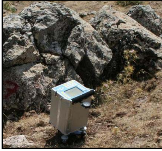
Foto 6.9. Fethiye-Gökben mevkinde mikrogravite ölçüm görüntüsü
