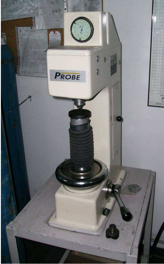
Şekil 4.6. Sertlik test cihazı (ALFA döküm fabrikası/ Ankara)
