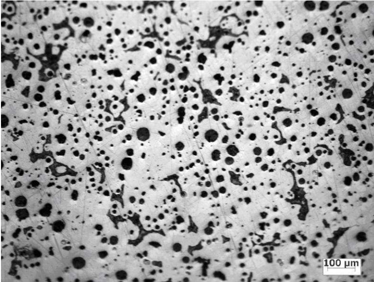
Şekil 5.8. 12mm kalınlığındaki Barinoc aşıl原因ıcı kullanılmış döküm numunesinin mikroyapısı
