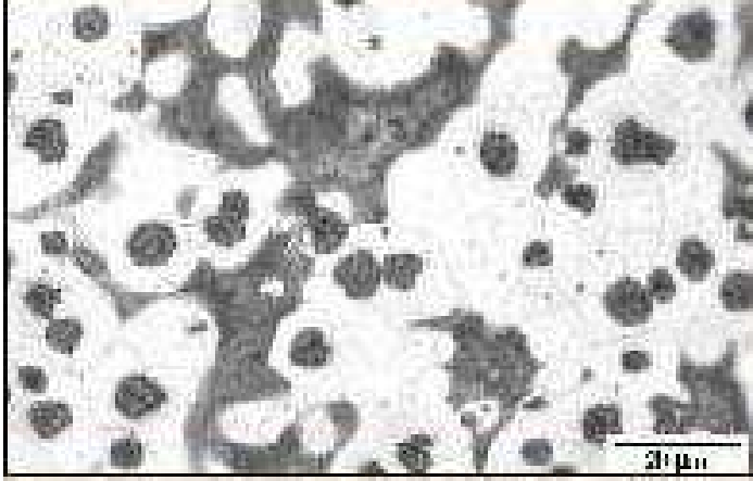
Şekil 2.3. Ferritik-Perlitik küresel grafitli dökme demir mikroyapısı. % 3 Nital çözeltisi ile dağlanmıştıır (x100) [8]
