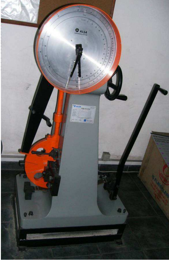
Şekil 4.7. Darbe test cihazı (ALFA döküm fabrikası/ Ankara)
