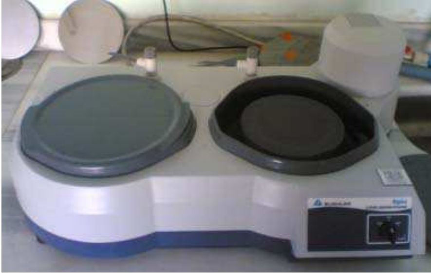
Şekil 4.3. Metalografik parlatma cihazı (Sakarya Üni. Plazma Sprey Lab.)
