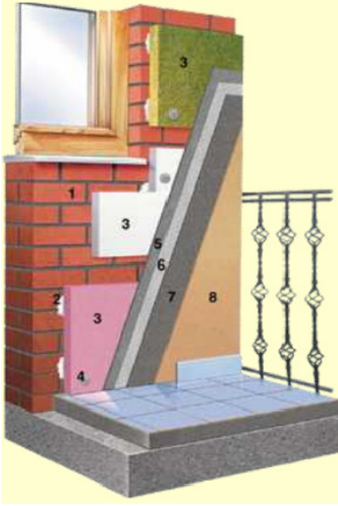
Şekil 4.8. Levha Halindeki Isı Yalıtım Malzemelerin Duvara Uygulanışı
