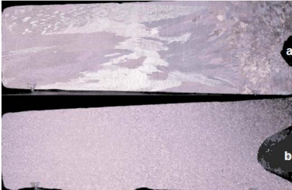
Şekil 2.2a-Tane inceltilmemiş, b-Al5Ti1B bileşiminde 10 ppm bor ilave edilmiş 3004 alaşımının tane yapıları[1].
