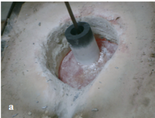
Şekil 3.3a. Sıvı metalin azot gazı ile yıkanması,
