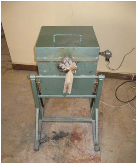
Şekil 3.1. Elektrik direnç ergitme ocağı
