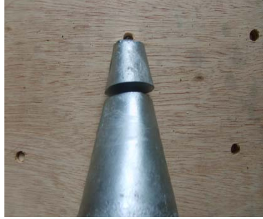
Şekil 3.8. Kesilmiş tane inceltme külçesi
