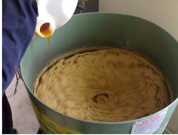
Şekil 3.12. Karıştırma mikserinde kumun hazırlanması
