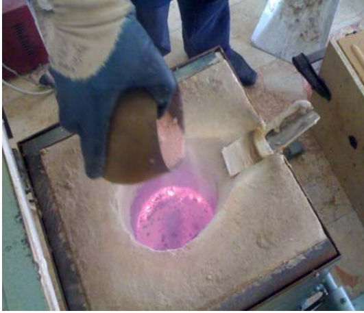
Őekil 3.16. Sıvı metale curuflařtırıcı toz atılması
