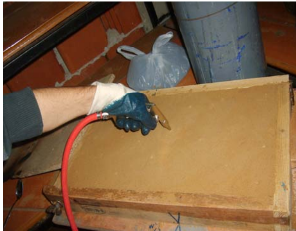
Şekil 3.13. Kumun CO 2 gazı ile sertleştirilmesi
