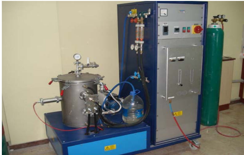
Şekil 4.4. Yüksek sıcaklık grafit fırını
