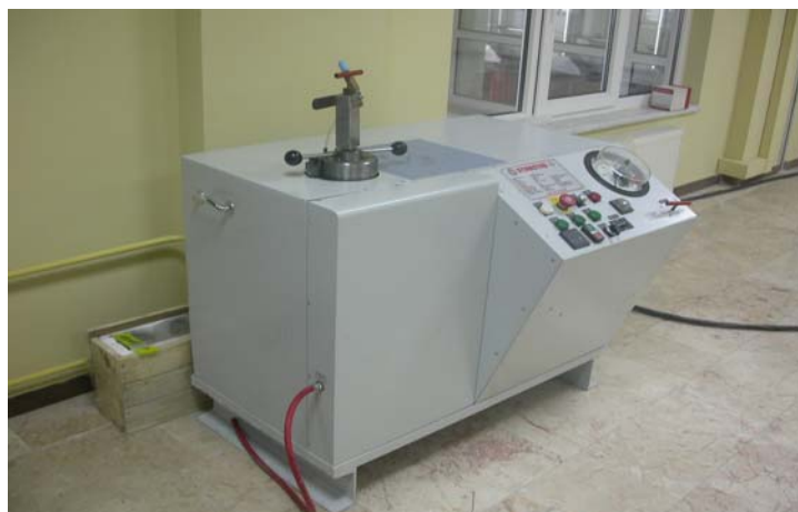
Şekil 4.3. (CIP)Soğuk izostatik pres.
