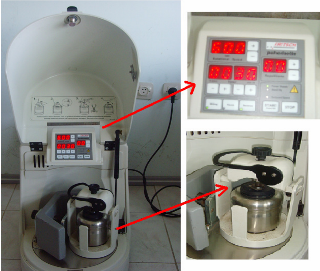
Şekil 4.2 Deneysel çalışmalarda kullanılan gezegensel değirmen
