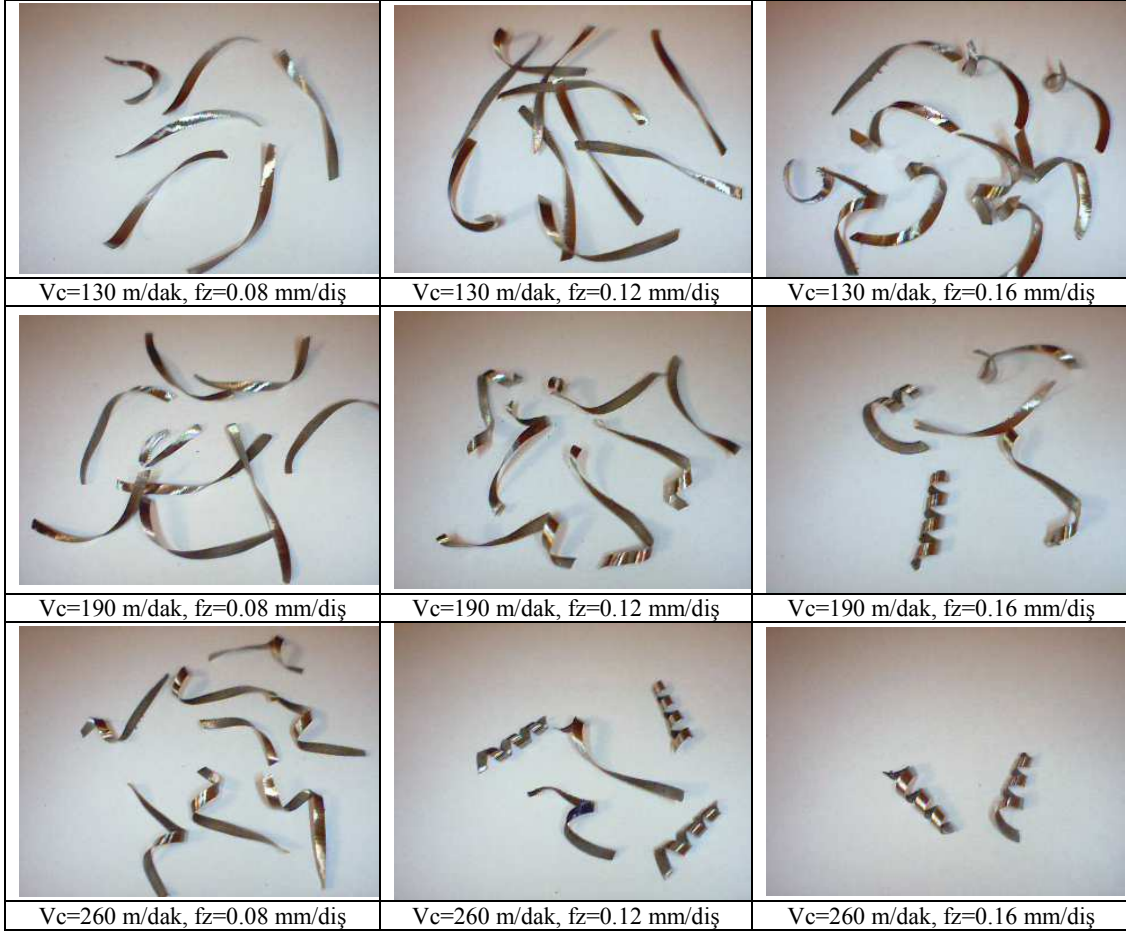
Şekil 7.26. PVD-TiAlN kaplamalı takımla, AISI 304'ün işlenmesinde çeşitli kesme değerlerine göre oluşan talaş şekilleri
