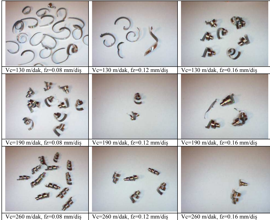
Şekil 7.29. PVD-TiAlN+TiN kaplamalı takım ile, AISI 304'ün işlenmesinde çeşitli kesme değerlerine göre oluşan talaş şekilleri
