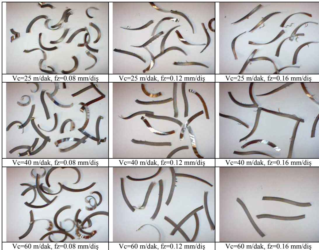
Şekil 7.13. CVD- TiCN+Al_2O_3+TiN kaplamalı takımla, Inconel 625'in işlenmesinde çeşitli kesme değerlerine göre oluşan talaş şekilleri
