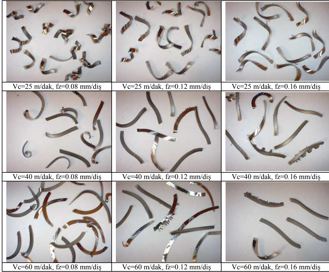
Şekil 7.11. PVD-TiAlN+TiN kaplamalı takımla, Inconel 625'in işlenmesinde çeşitli kesme değerlerine göre oluşan talaş şekilleri
