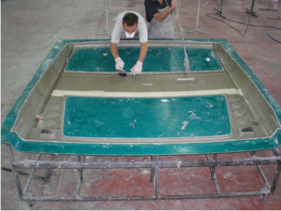
Şekil 4.18. Arka duvar üretiminde elyaf ve polyester uygulaması
