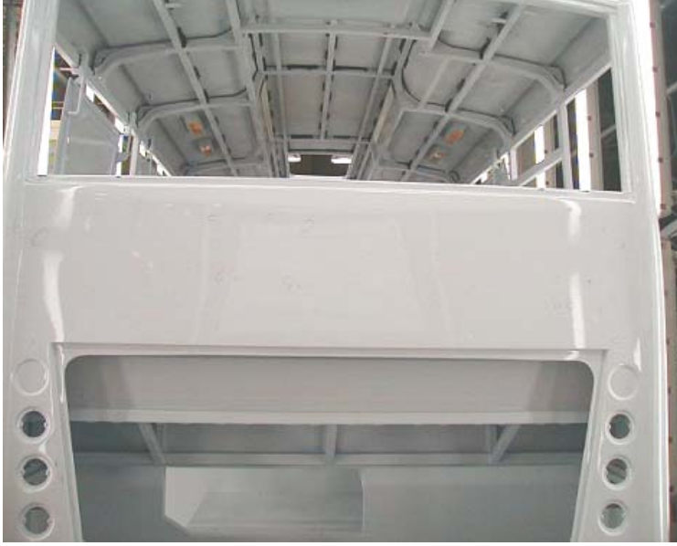
Şekil 4.8: Araç üzerine monte edilmiş boyalı FRP arka duvar
