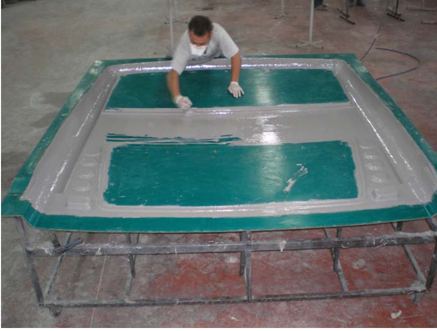
Şekil 4.17. Arka duvar üretiminde jelkot uygulaması
