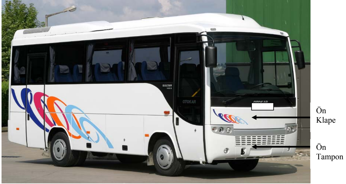
Şekil 4.4. KOTO üzerindeki ön klape ve ön tampon
