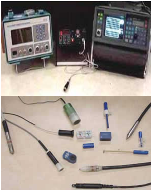
Şekil 4. 53. NDT Deneylerinin yapıldığı bir girdap akımla muayene cihazının görünümü ve çeşitli problemler.
