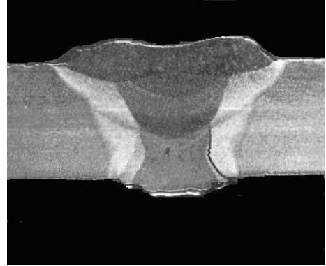
Şekil 5. 23. Çatlak, köke bitişik A-A kesiti
