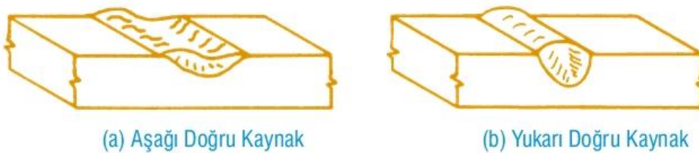
Şekil 3.5. İş parçası eğiminin kaynak dikişine şekline etkisi
