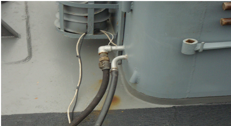
Şekil 5.8. C sınıfı gemiye ait sahil bağlantısı resmi
