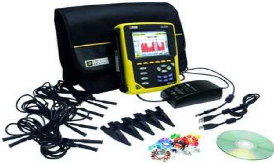
Şekil 6.6. Ölçüm yapılan enerji analizörü ve ekipmanlarının resmi
