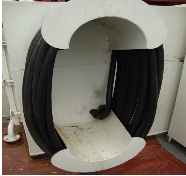
Şekil 5.5. B sınıfı gemiye ait sahil bağlantısı resmi
