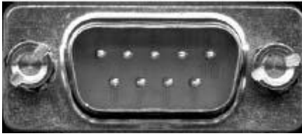
Şekil 4.2. RS232 DB-9P Konektörün Fiziksel Görünüşü [4]
