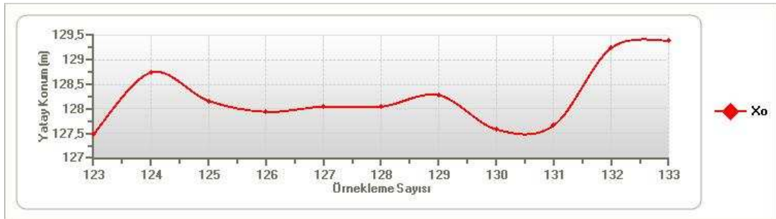
Şekil 3.64. C=1500 , x=128 m, z=5 m, Q=30^0 için üretilen gürültü eklenmiş teorik yatay silindir modeline ait konum çözümleri
