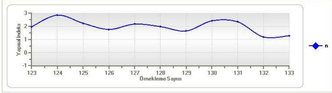
Şekil 3.66. C=1500 , x=128 m, z=5 m, Q=30^0 için üretilen gürültü eklenmiş teorik yatay silindir modeline ait yapısal indeks çözümleri
