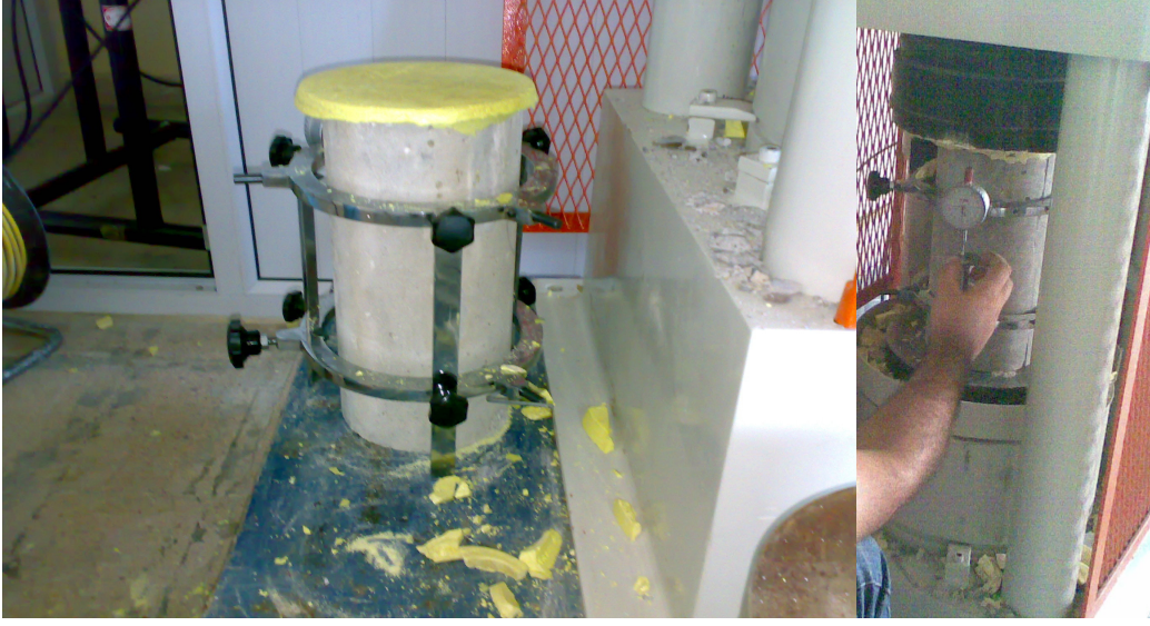
Şekil 3.6. Elastisite modülü tayini deney numunesi ve aleti
