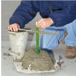
Şekil 3.1 Slump Deneyi sırasında slump değerinin ölçülmesi
