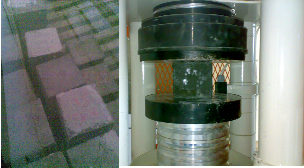
Şekil 3.2. Uygun koşullarda saklanan numuneler ve beton basınç deney presi
