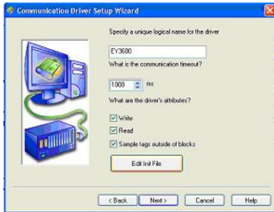
Şekil A.17. NovaproOpen'da projede kullanılacak sürücülerin ayarlandığı pencere
