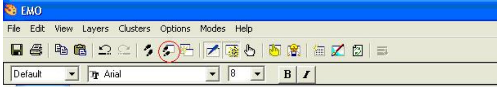
Şekil A.44. NovaproOpen’da zone olarak tanımlanmış alanlara gitmek için tıklanacak buton
