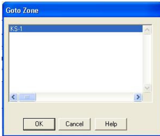
Şekil A.45. NovaproOpen’da zone olarak tanımlanmış alanlara gitmek için kullanılan menü
