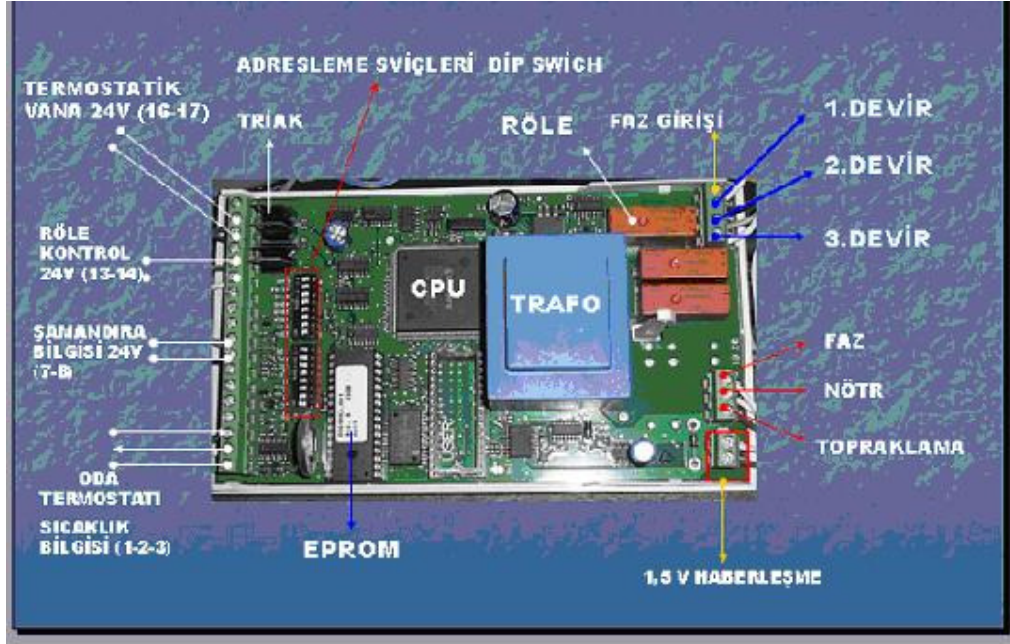
Şekil B.6. ECOS EYE 200 DDC klemens bağlantı şekli
