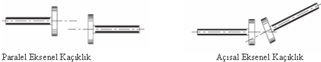
Şekil 3.15. Paralel aksenal kaçıklık ve açısal aksenal kaçıklık
