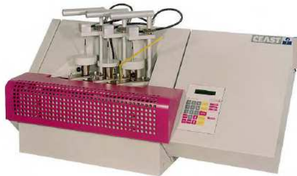
Şekil 5.7. Yük altında eğilme sıcaklığı (HDT) cihazı
