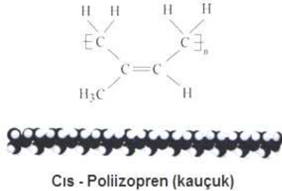
Şekil 2.2. Doğal polimer örneği ve kauçuk doğal polimerinin kimyasal yapısı
