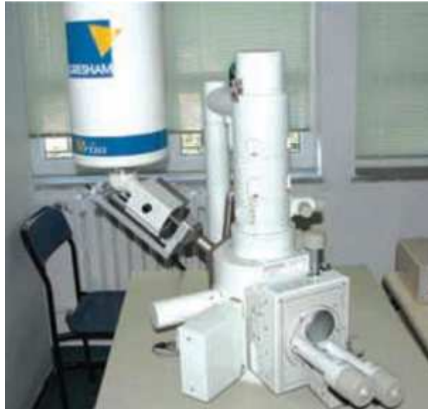
Şekil 5.12. Taramalı Elektron Mikroskop cihazı
