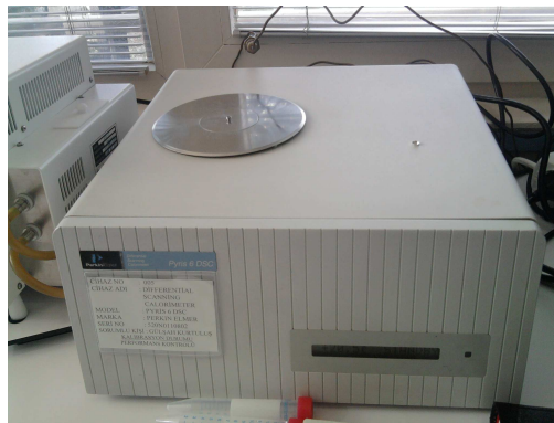
Şekil 5.9. Deneylerde kullanılan diferansiyel taramalı kalorimetre (DSC) cihazı
