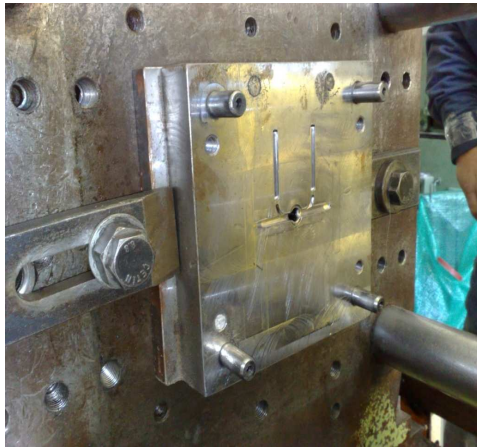
Şekil 5.5. Enjeksiyonda üretilen test numune kalıp resmi
