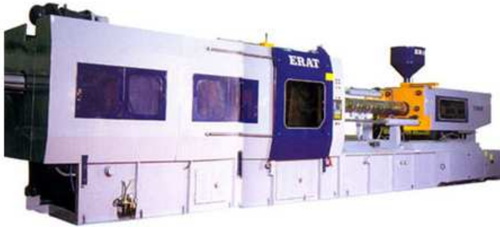
Şekil 5.4. Enjeksiyon prosesinde kullanılan ERAT marka enjeksiyon makinesi
