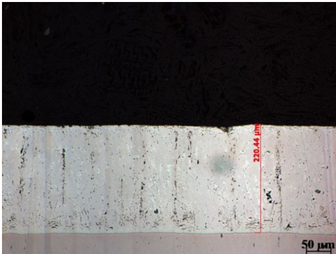
Şekil 8.16. 1A8 numunesinin tabaka kalınlığı ölçümü: 220,44 µm
