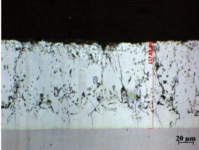
Şekil 8.15. 1A4 numunesinin tabaka kalınlığı ölçümü: 117,85 µm
