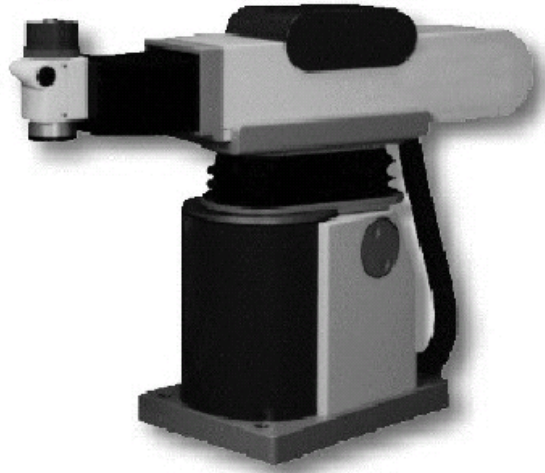
Şekil 1.4. Seiko RT3300 silindirik robotu
