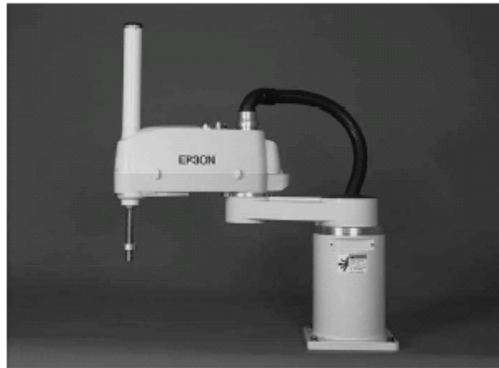
Şekil 1.6. Epson E2L653S SCARA robotu
