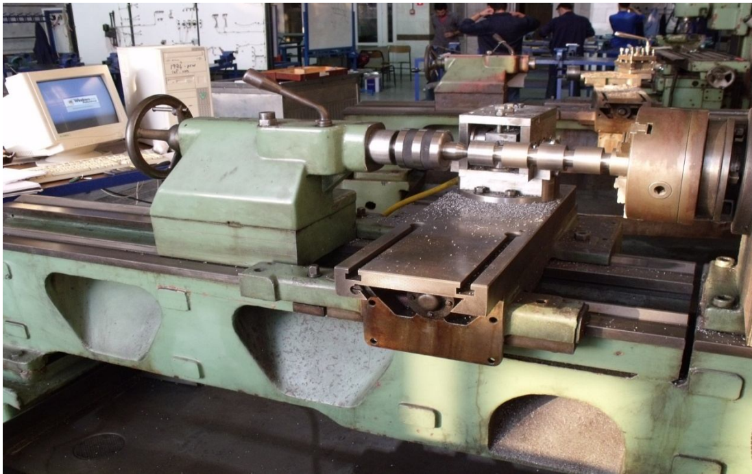
Şekil 6.8. Deney numunesi olarak kullanılan otomat çeliğinin torna tezgahındaki görüntüsü ve kesme kuvveti, ilerleme kuvvetinin ölçüldüğü sistem
