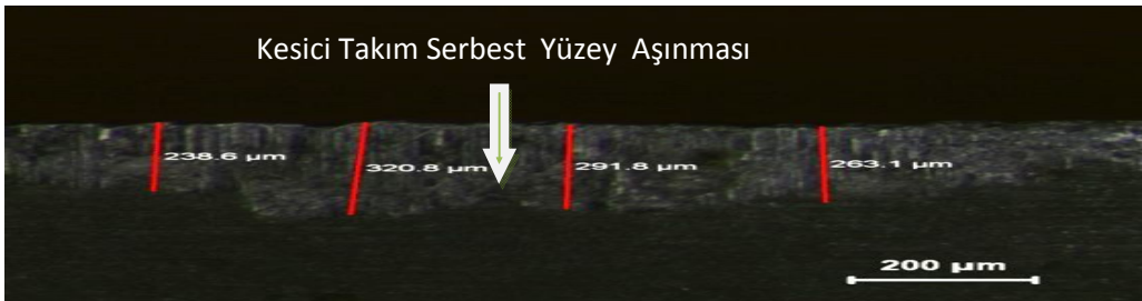
Şekil 7.42. Talaş kaldırma işlemi sonrasında kesici takımın serbest yüzeyinde meydana gelen aşınmalar
