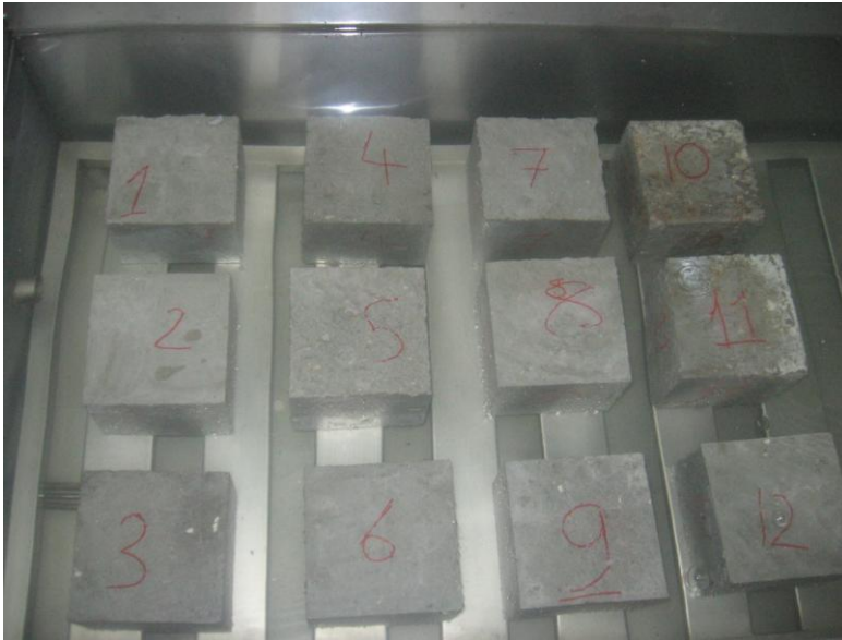
Şekil 4.2. Kür banyosunda numunelerin bekletilmesi
