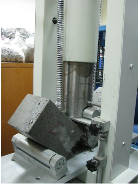
Şekil 4.4. Eğme dayanımı testi uygulanmakta olan bir kiriş numune
