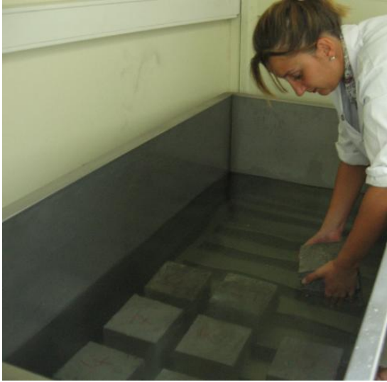
Şekil 4.5.Su emme numunelerinin kür havuzundan alınması
