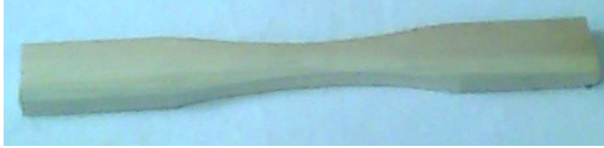
Şekil 4.5. Ahşap kalıp numunesi
