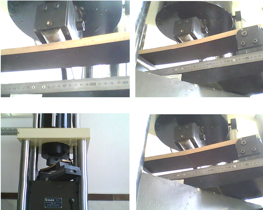
Şekil 5.38. Plywood kalıp numunesin deney cihazına yerleştirilmesi ve deneyin uygulanışı
