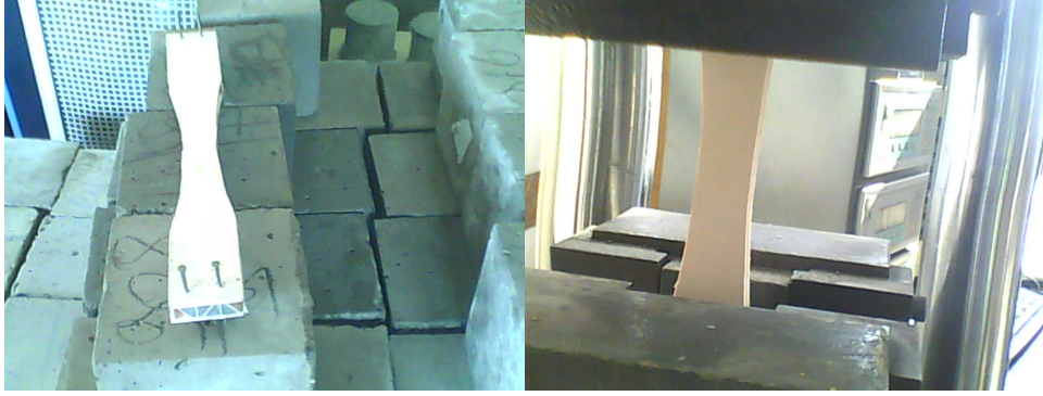
Şekil 5.18. Pladeck kalıp numunesi ve çekme makinesine yerleştirilmesi
