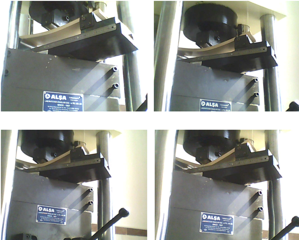
Şekil 5.44. Pladeck kalıp numunesin deney cihazına yerleştirilmesi ve deneyin uygulanışı
