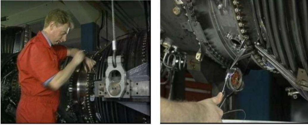
Şekil 4.18. Alçak basınç türbininin motora bağlanması[2]
