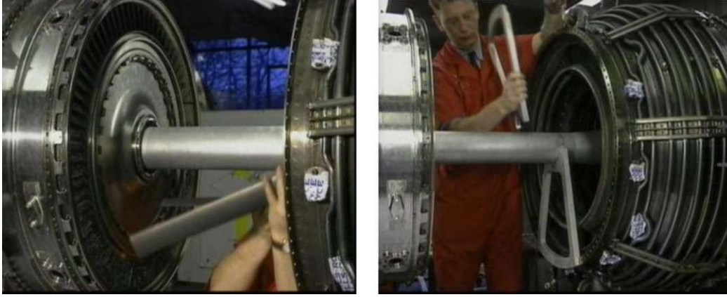
Şekil 4.16. Kanatçıkları koruyan aparatın ve Alçak basınç mili desteğinin sökülmesi[2]
