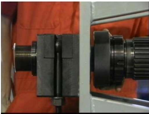
Şekil 4.10. Alçak basınç milinin taşıma aracının ön kısmına bağlantı şekli[2]
