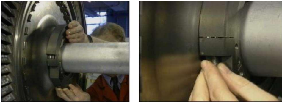
Şekil 4.6. Kanatçık koruyucu aparatının sabitlenmesi[2]
