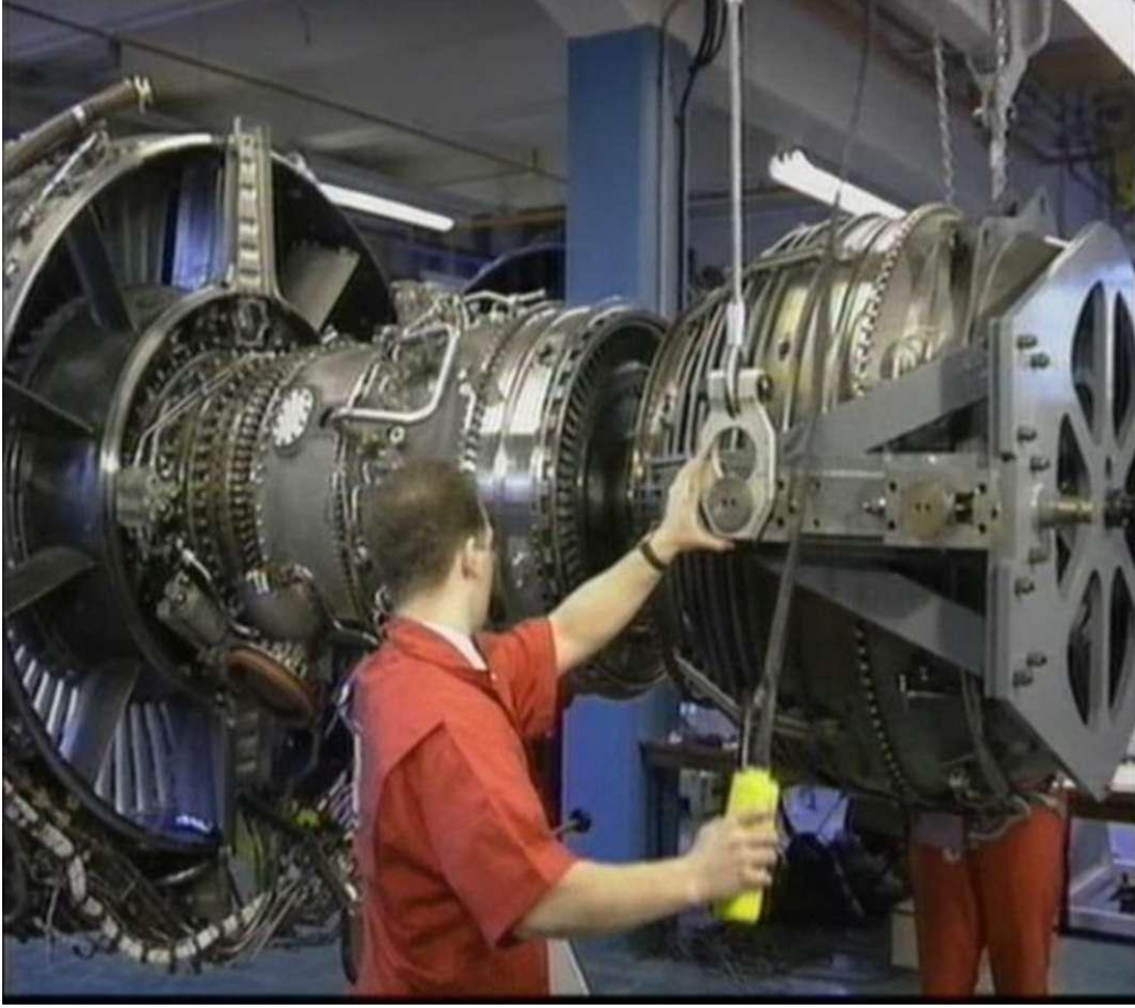
Şekil 4.5. Alçak basınç modülün motordan ayrılması [2]
