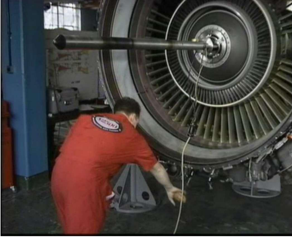
Şekil 4.3. Ön kısımdaki yataklama aparatı ve itici mil [2]
