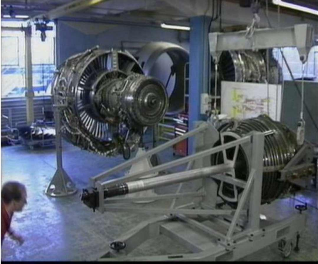
Şekil 4.11 Taşıma aracına bağlanmış şekilde Alçak basınç türbini[2]
