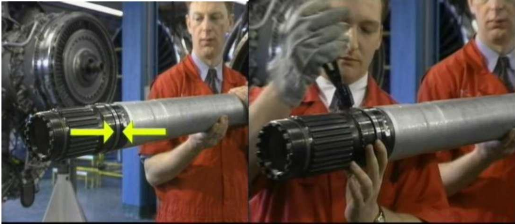
Şekil 4.13. Alçak basınç modülüne ölçüleri hesaplanan bileziğin takılması [2]
