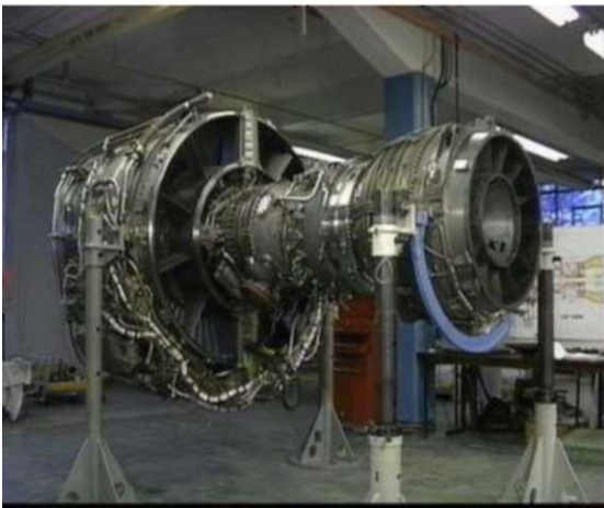
Şekil 4.20. Alçak basınç türbininin bağlanmasından sonra motorun tamamı[2]
