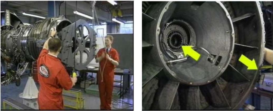
Şekil 4.19. Alçak basınç türbininin arka aparatının sökülmesi ve mil türbin eksenlilik kontrolü[2]
