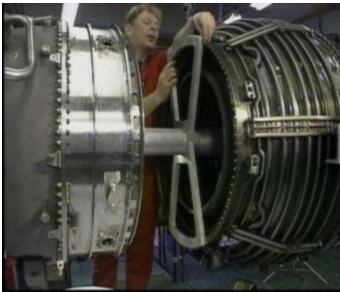
Şekil 4.8. Alçak basınç milini desteklemek için takılan aparat ve itici mili destekleyen aparat[2]
