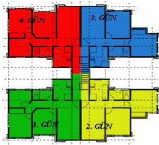
Şekil2.2. Tünel Kalıp ile imalatta Rotasyon
