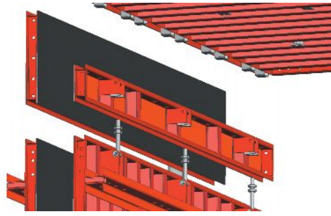
Şekil 3.5. Modüler dik pano ve ilave üst adaptör
