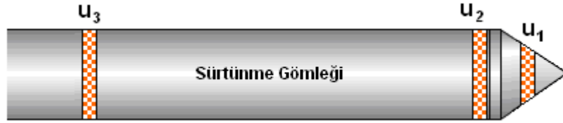
Şekil 3.6. Boşluk suyu basıncı ölçümü için filtrenin koni üzerinde farklı konumları (Önalp ve diğ., 2008)
