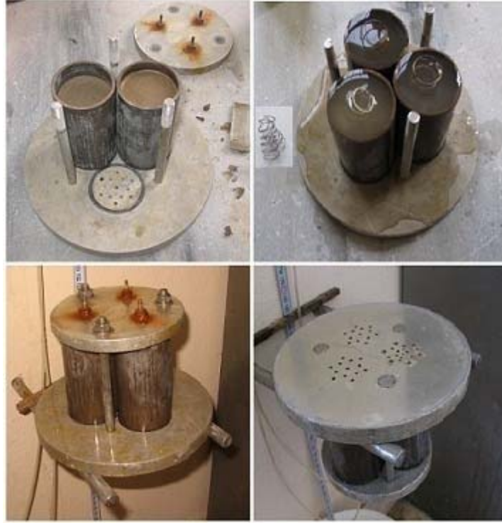
Şekil 3.18. Permeametre numunelerinin doygun hale getirilmesi
