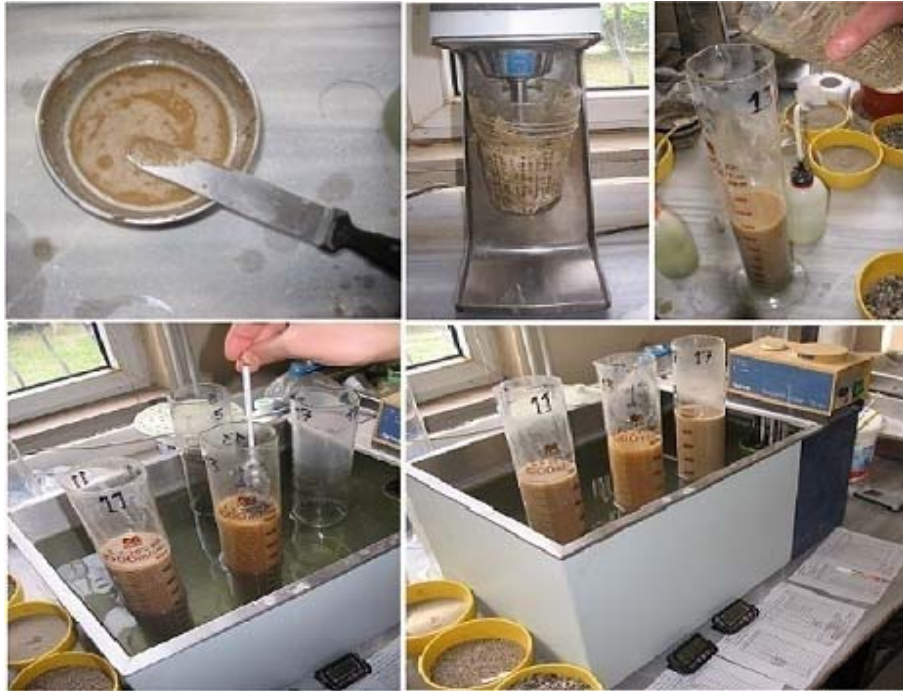
Şekil 3.15. Hidrometre deneyine ait resimler
