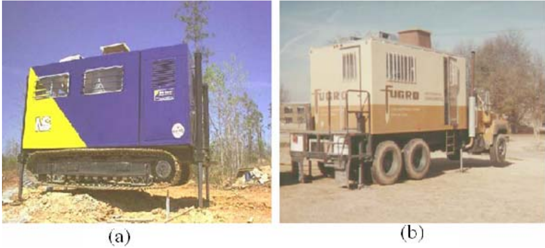
Şekil 3.4.a. Paletli sisteme monte edilmiş CPT ekipmanı (Van Der Berg Track Rig.) b. Kamyona monte edilmiş CPT ekipmanı (Fugro Geosciences)
