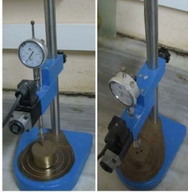
Şekil 3.12. Koni düşürme (penetrasyon) yöntemi ile likit limit belirlenmesine ait resimler
