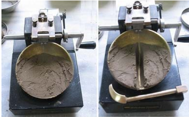
řekil 3.11. Casagrande yöntemiyle likit limitin belirlenmesine ait resimler
