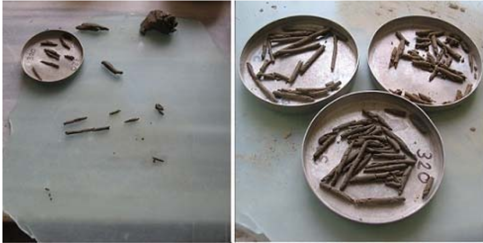
Şekil 3.13. Plastik limitin belirlenmesine ait resimler
