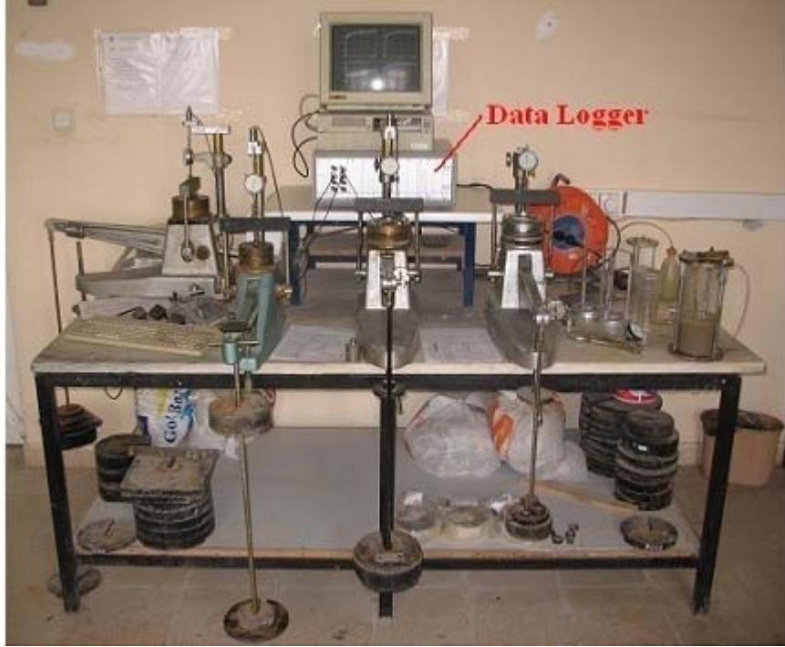
Şekil 3.17. Konsolidasyon (ödometre) deney düzeneği
