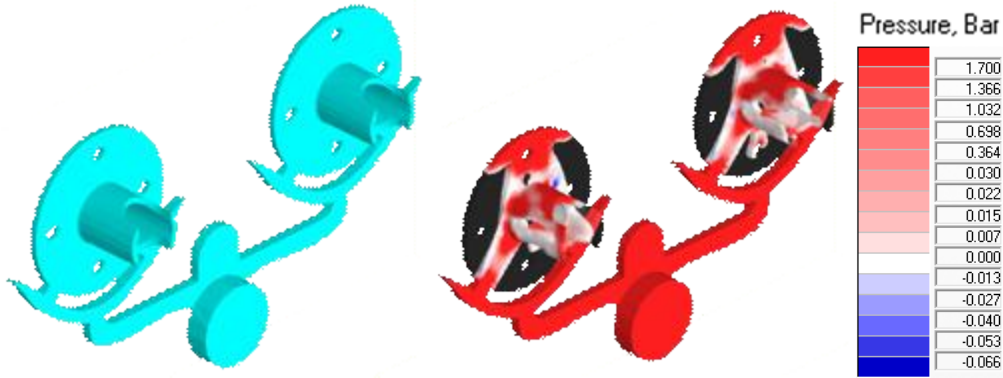
Şekil 4.25. İki gözlü ve dört yolluk girişli bir başka kalıp tasarımı ve doluş simülasyonu
