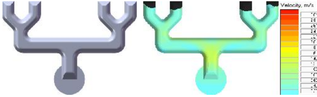
Şekil 4.15. Dört yolluk girişine sahip yatay dağıtıcı bir sistemde sıvı metal hızının değişimi
