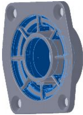
Şekil 7.6. Katılma sırasında maçayı sıkacak yüzeyler
