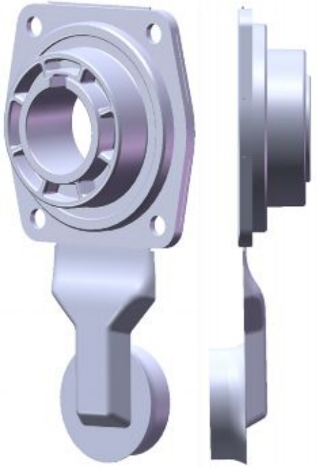
Şekil 7.18. Yayıcı tip yolluklu modelin katı model görünümü
