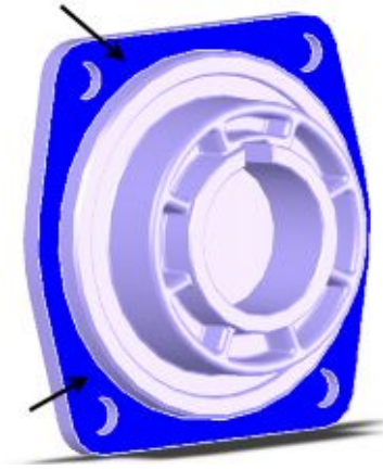
Şekil 7.7. Belirlenen kalıp ayırma yüzeyinin parça üzerinde gösterimi
