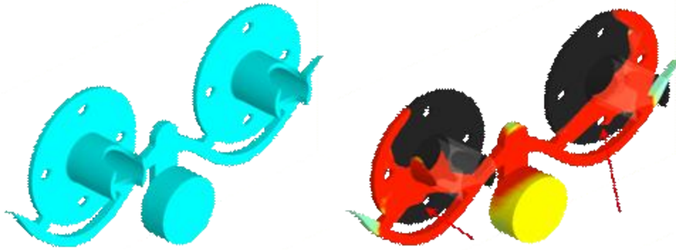
Şekil 4.24. İki gözlü ve dört yolluk girişli bir kalıp tasarımı ve doluş simülasyonu
