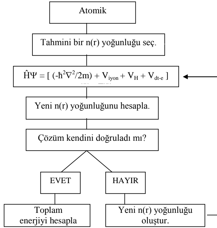
Şekil 3.1. Bir kristalin toplam enerjisini kendini doğrulama metodunu kullanarak hesaplayan bir bilgisayar programının akış çizelgesi
