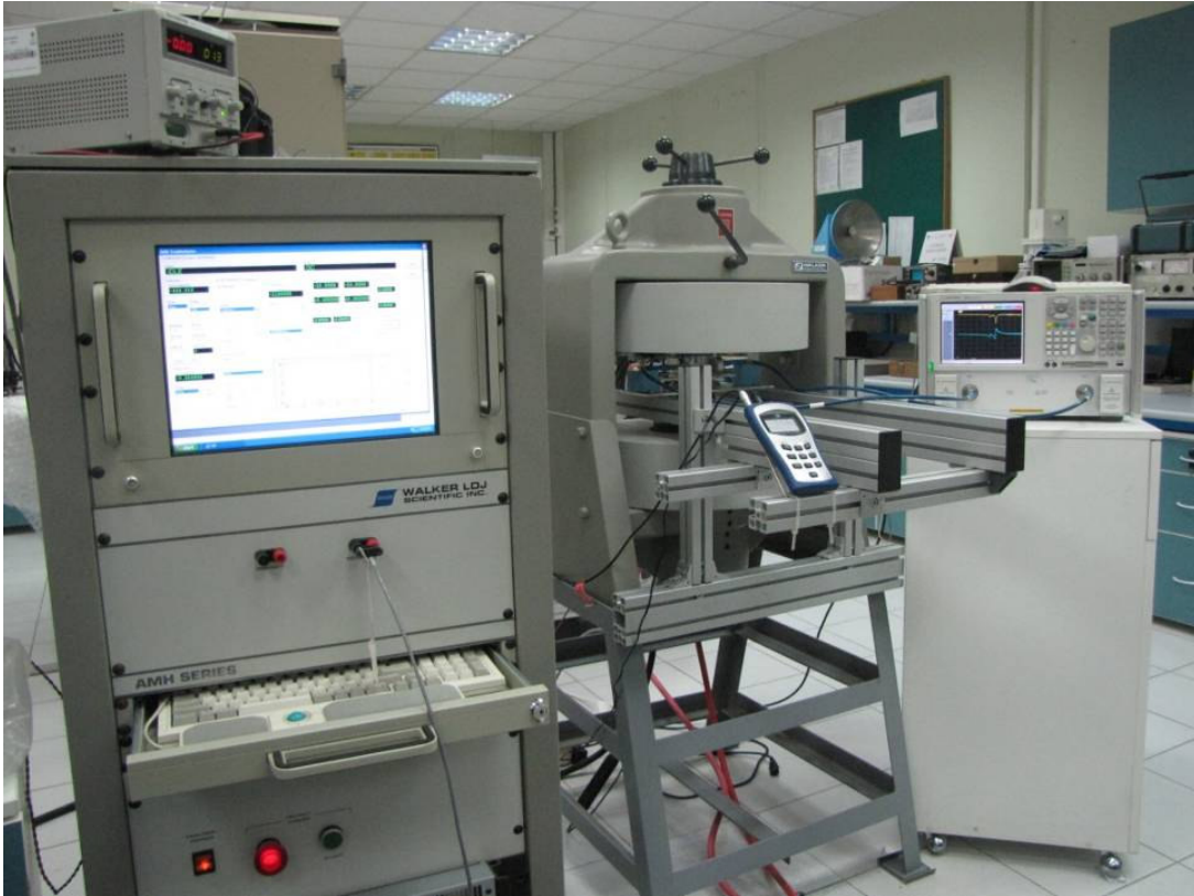
Şekil 3.14. FMR Spektroskopisi Düzeneği
