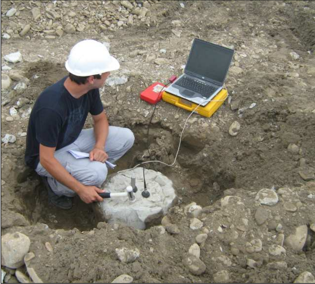
Şekil 5.10. Arazide süreklilik deneyi uygulaması
