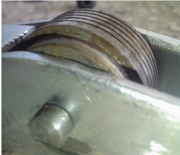
Şekil 5.3. Test sonrası silindirlerde meydana gelen deformasyon
