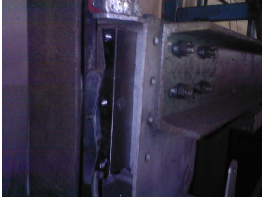
Şekil 5.1. Test sonrası frenlerin görünümü
